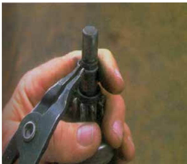
شکل ۸-۶۱ – درآوردن خار رینگی
