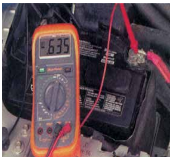
شکل ۸-۳۷ – اندازه‌گیری افت ولتاژ جریان ورودی کابل استارتر
