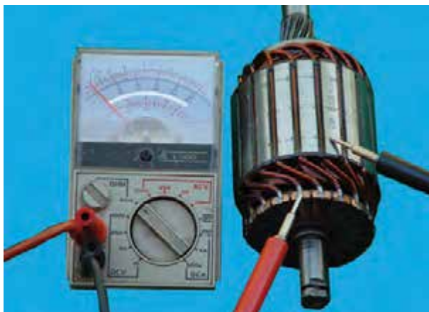
شکل ۸-۶۷- آزمایش اتصال کوتاه شدن آرمیچر
