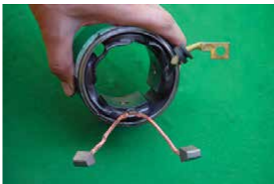
ب - زغال مثبت و محل لحیم آن شکل ۸-۲۲ زغال یا جاروبک استارتر
