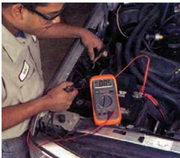
شکل ۸-۴۰- اتصال سیم منفی ولت‌متر به ورودی رله
