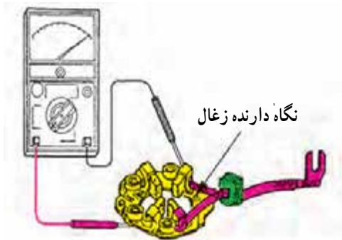
شکل ۸-۷۲- بررسی اتصال بدنه‌ی نگاه‌دارنده‌ی زغال
