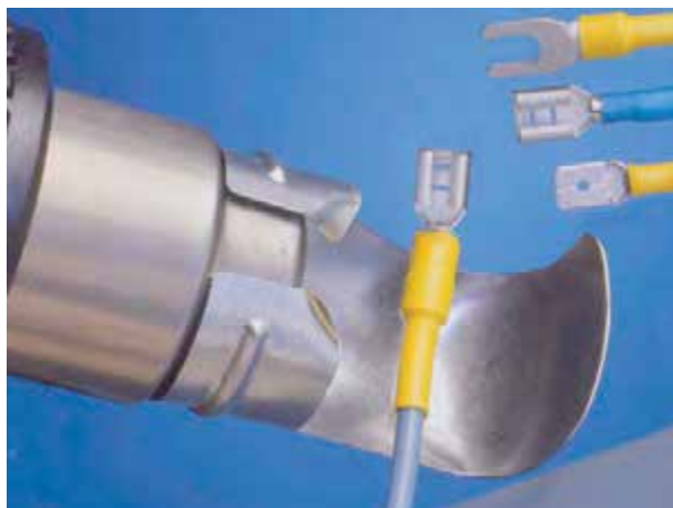
شکل ۷۹-۸- عایق‌کاری اتصال سرسیم به سیم
