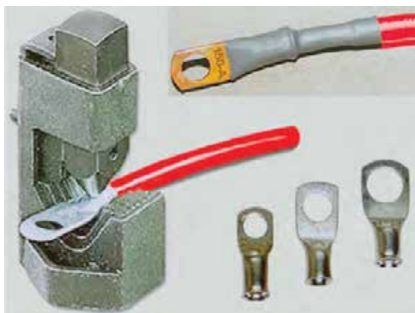
شکل ۸۰-۸- اتصال بست به کابل باتری
