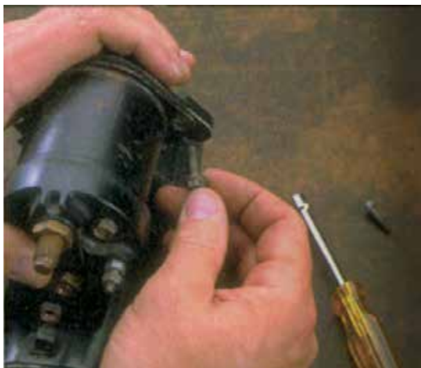
شکل ۸-۵۳ - بیرون آوردن پیچ‌های اتومات
