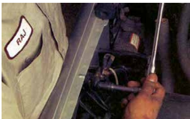
شکل ۸-۴۵ - اندازه‌گیری افت ولتاژ رله‌ی استارتر
