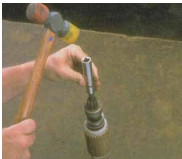
شکل ۸-۵۹ – ضربه زدن با چکش روی خار
