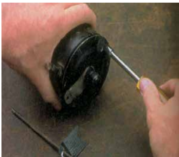
شکل ۸-۵۵ - باز کردن پیچ‌های اتصال درپوش به بدنه
