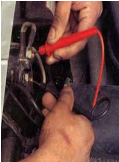
شکل ۸-۴۲- اتصال فیس‌های ولت‌متر به اتومات استارتر
