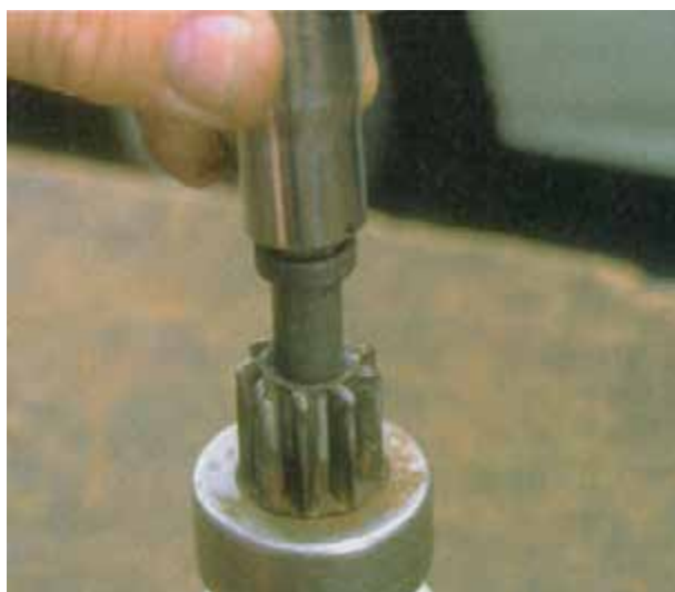
شکل ۸-۶۰ – خارج کردن حلقه رینگی از شیار شافت
