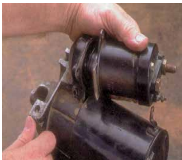
شکل ۸-۵۴ - خارج کردن اتومات
