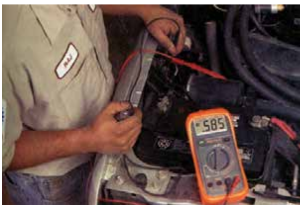
شکل ۸-۴۴- اندازه‌گیری افت ولتاژ پلاتین‌های سولونویید استارتر
