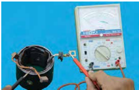
شکل ۸-۷۵ - آزمایش اتصال بدنه‌ی بالشتک
