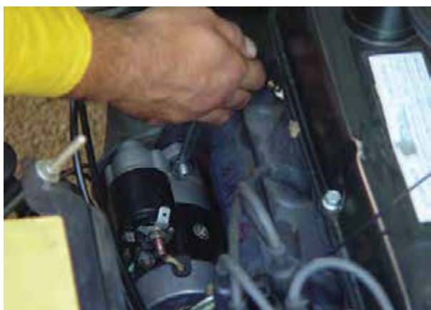
الف- باز کردن پیچ‌های استارتر
