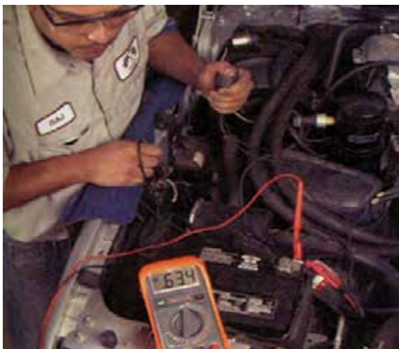
شکل ۸-۳۹- آزمایش افت ولتاژ باتری به خروجی رله
