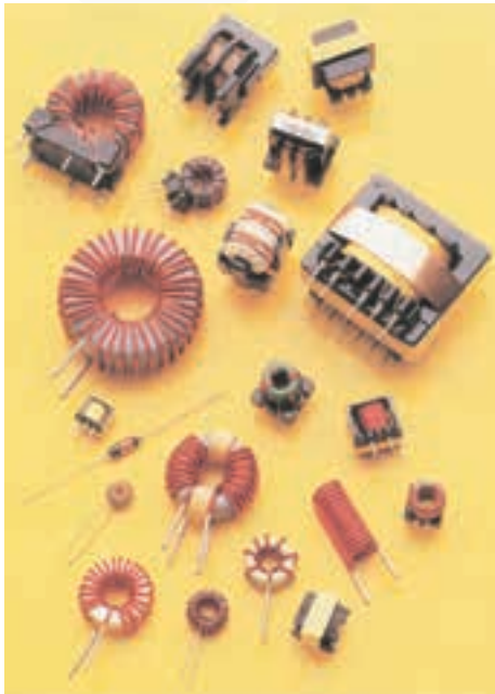
شکل ۲۵-۲- نماد فنی و تصویر ظاهری چند نمونه سلف
