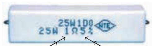
تولرانس ۵ درصد مقدار مقاومت یک اهم
