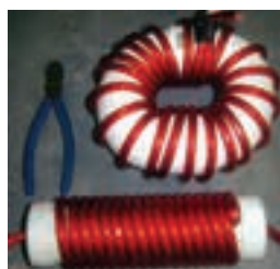
سلف پیچیده شده روی قرقره بدون هسته
