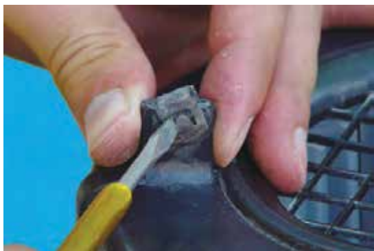
شکل ۴-۳۸- باز کردن ضامن خار
