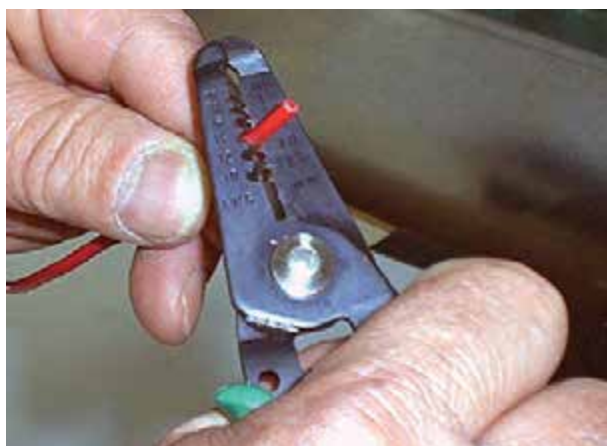
شکل ۴-۶۴- جدا کردن عایق سیم‌ها
