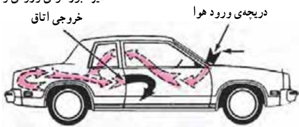
شکل ۱۱-۴- مسیر عبور جریان هوای گرم در خودرو
