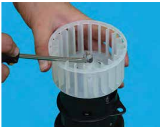
شکل ۴-۴۲- درآوردن خار نگهدارنده‌ی فن
