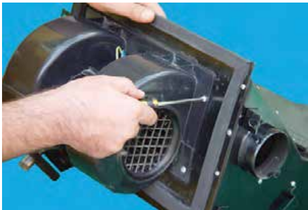
شکل ۴-۳۶ – باز کردن پیچ‌های محافظه‌ی موتور
