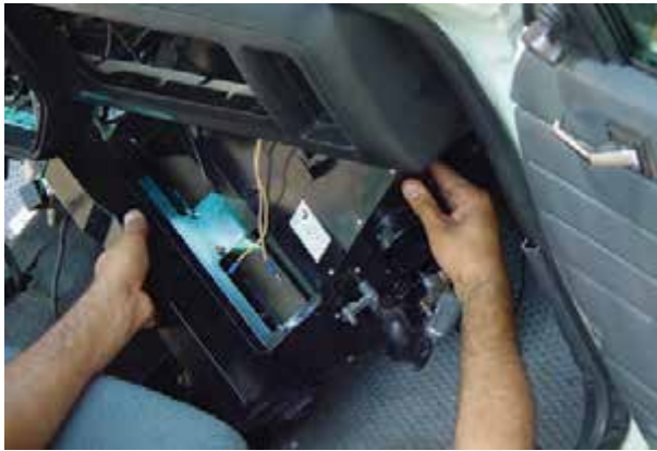
شکل ۴-۳۴ – خارج کردن بخاری از محل نصب آب
