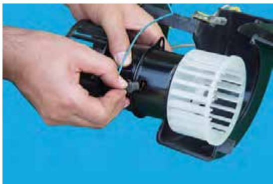
شکل ۴-۴۱- جدا کردن سیم از زغال‌ها
