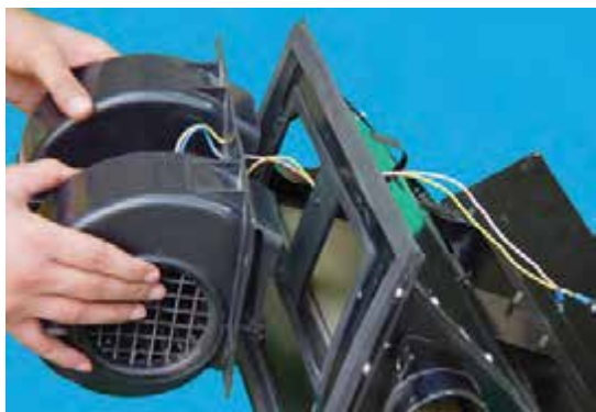
شکل ۴-۳۷- جدا کردن محفظه‌ی موتور از بخاری
