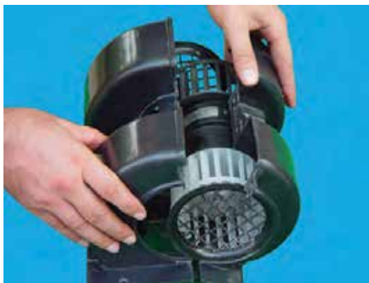
شکل ۴-۴۰- جدا کردن محفظه‌ی نگهدارنده‌ی موتور
