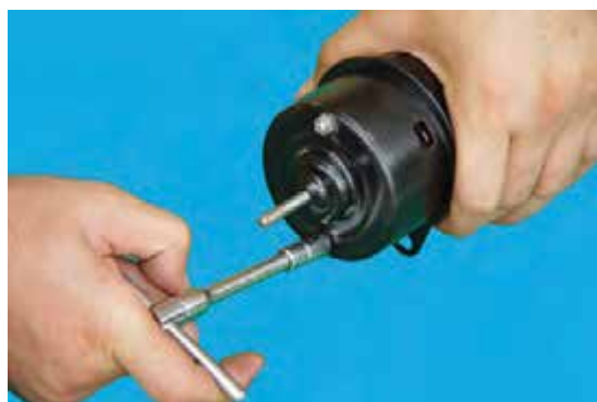
شکل ۴-۴۴- باز کردن پیچ‌های پوسته‌ی موتور
