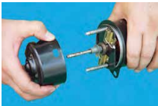
شکل ۴۵-۴ جدا کردن پوسته‌ی موتور
