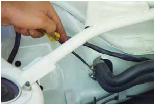
شکل ۴-۳۱- باز کردن لوله‌های آب رادیاتور بخاری
