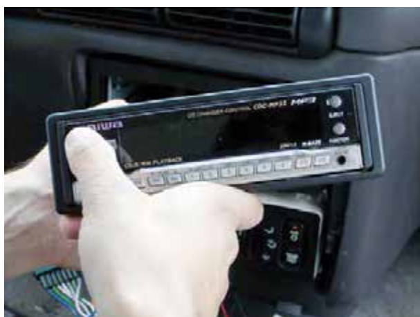
شکل ۲۸-۴- خارج نمودن رادیوپخش از داخل قاب کنسویی
