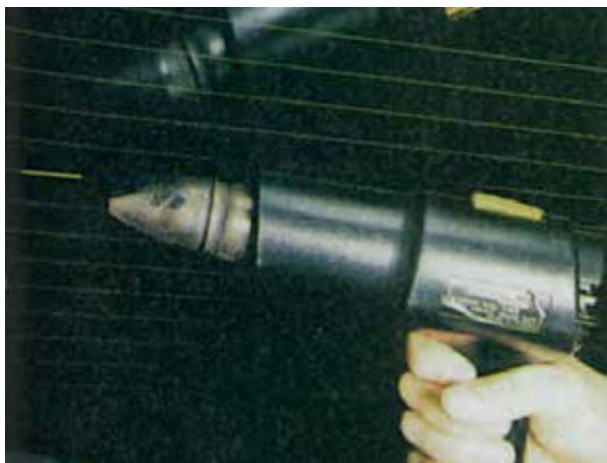
شکل ۲۷-۳- حرارت دادن محل تعمیر
