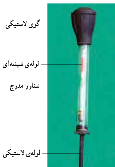
شکل ۱-۱۴- دو نوع هیدرومتر یا چگالی سنج
