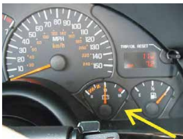
شکل ۱-۷۸ – نشان‌دهنده‌ی وضعیت شارژ باتری
