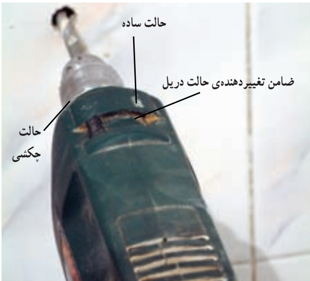
شکل ۲۱۲-۳ سوراخ کردن محل علامت‌گذاری شده
