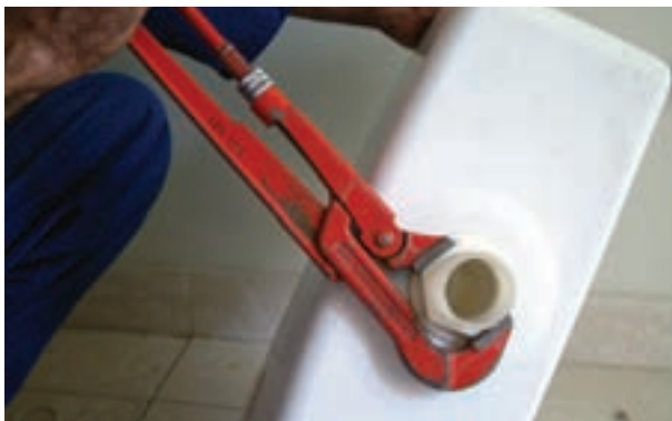
شکل ۳-۲۰۸- سفت کردن مهره‌ی پمپ تخلیه
