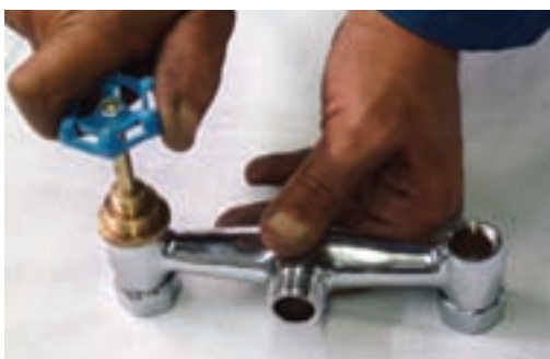
شکل ۲-۶۸- شیر تراش در حال کار شیر تراش
