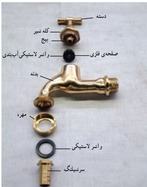
شکل ۱۲-۲- ب - اجزای شیر برنجی سرشیلنگی
