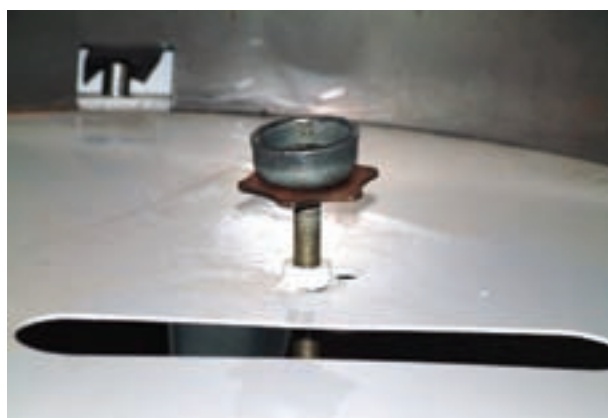
شکل ۹-۱- جک نصب شده بر روی شاسی
