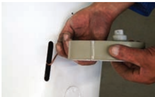
شکل ۵۶-۱- ب - قرارگیری صحیح بالب ترموستات در محل خود
