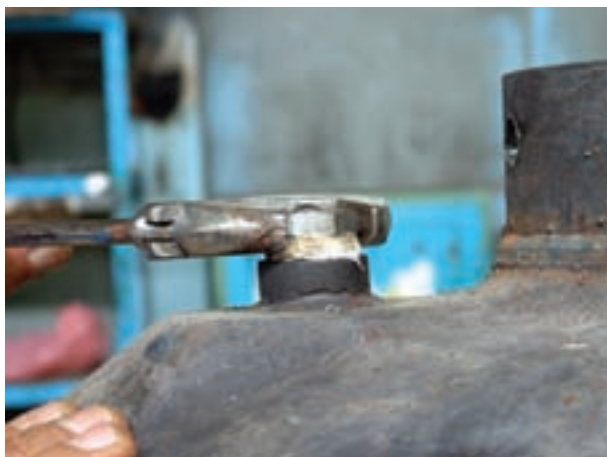
شکل ۱-۲۴- نحوه‌ی بازکردن میله‌ی منیزیم از محل خود
