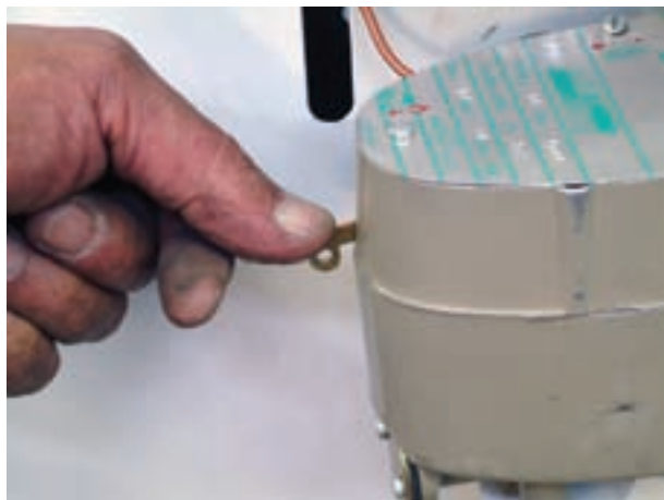
شکل ۱-۴۴ با فشار اهرم ریست به سمت پایین، نفت از مخزن سوخت به کار براتور می‌رود.
