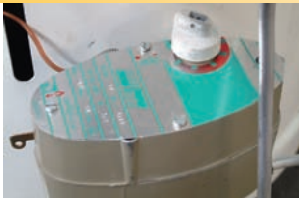
شکل ۱-۵۲- قرار دادن کلید گردان در حالت خاموش
