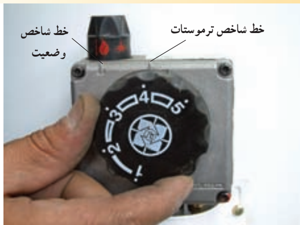
شکل ۱-۱۱۰- تغییر کلید تنظیم دما (ترموستات)
