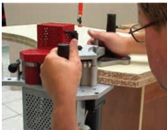
شکل ۱۰۷-۱۶- استقرار دستگاه روی ضخامت صفحه کار.
