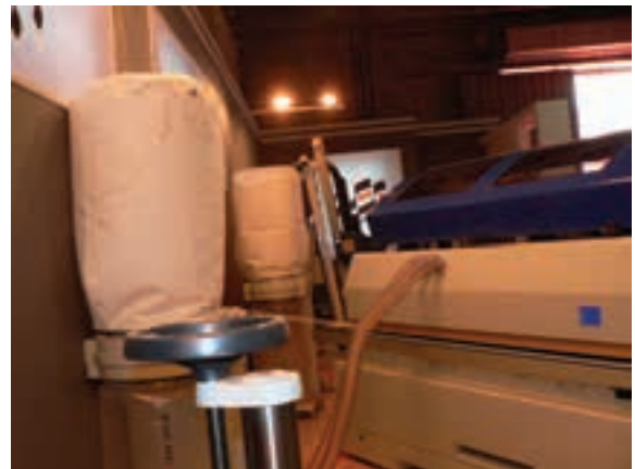
شکل ۱۴۹-۱۶- مکنده متمرکز متصل به ماشین لبه چسبان.
