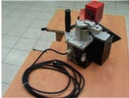
شکل ۹۵-۱۶- دستگاه لبه چسبان و میز کار مناسب.
