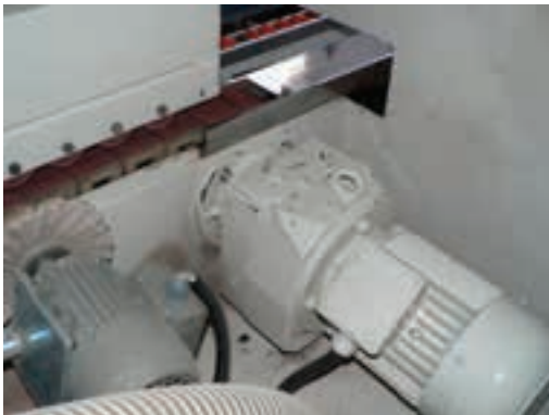
شکل ۲۱۵-۱۶- کنده شدن پوشش سیم متصل به الکتروموتور پولیش.
