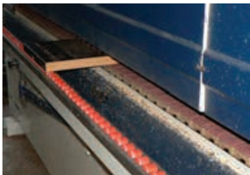
شکل ۱۸۵-۱۶. حرکت قطعه کار به صورت اتوماتیک.
