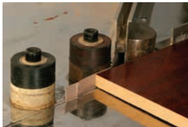
شکل ۱۳۵-۱۶- سر نوار قدری جلوتر از لبه صفحه کار.
