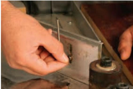
شکل ۱۳۲-۱۶- تنظیم کانال گره‌کن نوار برای عرض لازم.
