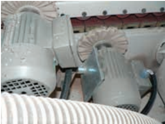
شکل ۱۷۶-۱۶- پولیش بالا و پایین لبه چسبان.
