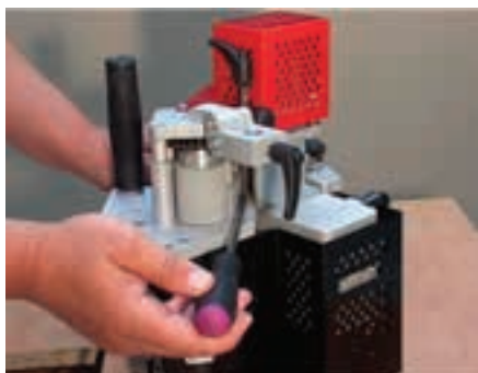
شکل ۱۶-۱۲۰- باز کردن پیچ تنظیم چسب.
