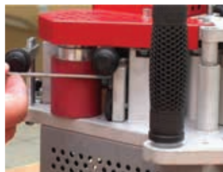
شکل ۱۰۶-۱۶- تنظیم ضخامت نوار با پیچ گوشتی.
