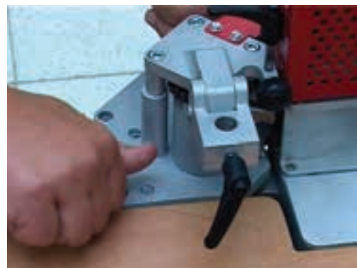
شکل ۱۱۳-۱۶- نصب دستگاه روی شابلون صفحه میز کار.
