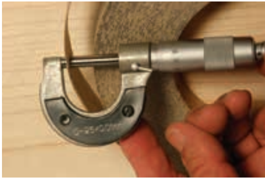
شکل ۱۲۵-۱۶- اندازه‌گیری ضخامت نوار با میکرومتر.
