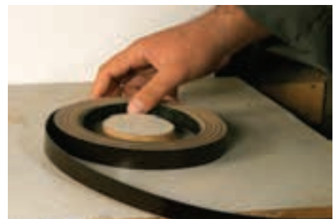
شکل ۱۳۱-۱۶- استقرار نوار در مقر میز کمک لبه چسبان.
