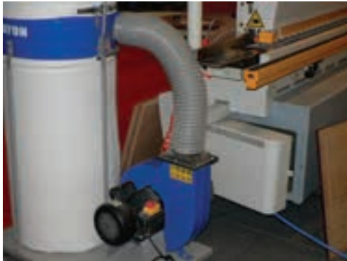
شکل ۱۶-۱۹۸- نصب مکنده به ماشین لبه چسبان.
