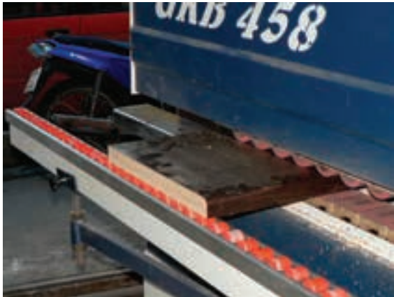
شکل ۱۸۰-۱۶- میز متمرک قرقره‌ای ماشین لبه‌چسبان.
