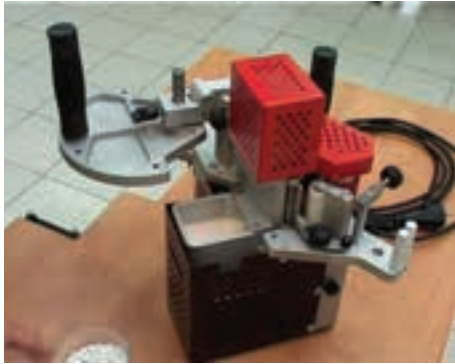
شکل ۹۹-۱۶- مخزن چسب گرانول و پیچ تنظیم چسب.
