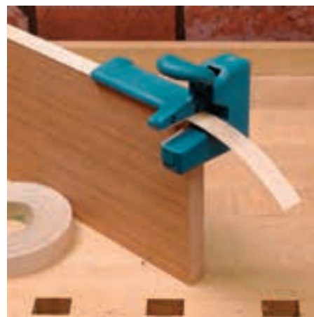
شکل ۱۶-۱۱۹- قطع اضافه سر نوار با گیوتین.
