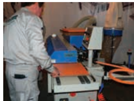
شکل ۲۰۹-۱۶- لبه چسبانی با استفاده از نوار چسب.
