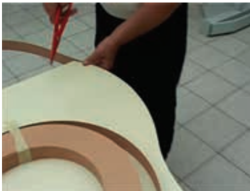
شکل ۱۰۳-۱۶- قطع کردن نوار لبه‌چسبان با قیچی.
