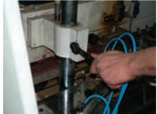
شکل ۱۸۲-۱۶. شل کردن بست ستون استقرار قسمت فوقانی.
