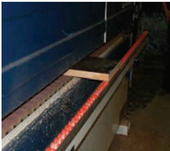
شکل ۱۶۹-۱۶- مرکت قطعه کار و بر فرود به میکروسوئیچ داخل ماشین.
