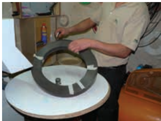
شکل ۱۶۵-۱۶- قطع بست نوار و استقرار آن روی میز.
