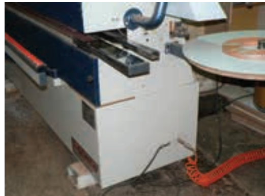
شکل ۱۷۸-۱۶- دهانه و روی صفحه کار برای لبه‌چسبانی.
