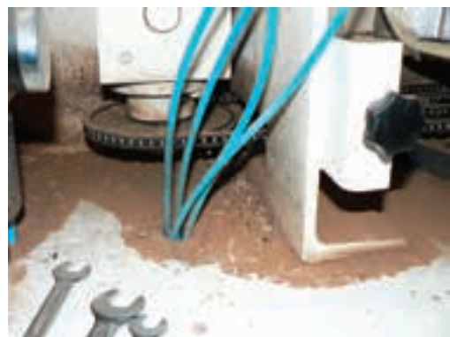
شکل ۲۰۱-۱۶- روغن کاری مومرها و چرخ زنجیرها.
