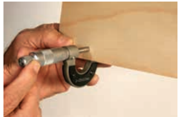
شکل ۱۶۰-۱۶. اندازه‌گیری ضخامت روکش با میکرومتر.
