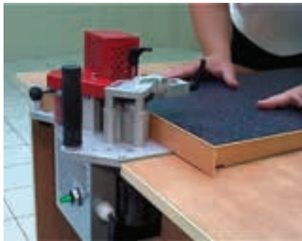
شکل ۱۱۸-۱۶- صفحه نازک زیر کار عقب تر قرار دارد.
