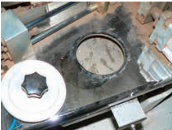
شکل ۱۷۷-۱۶- کنترل مجدد مخزن چسب.
