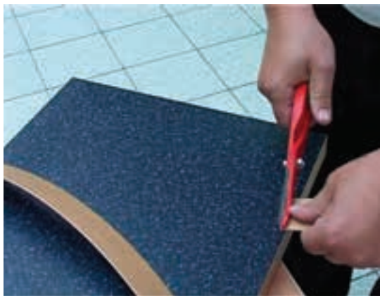
شکل ۱۱۴-۱۶- صاف کردن سر نوار با قیچی.
