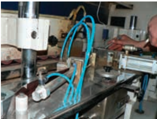
شکل ۱۷۳-۱۶- تنظیم میکروسوئیچ قطع نوار بوسیله اره گردها.
