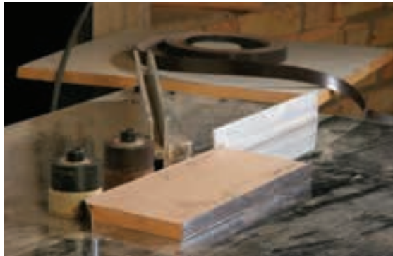
شکل ۱۲۹-۱۶- استقرار نوار (روی مقر مربوطه).
