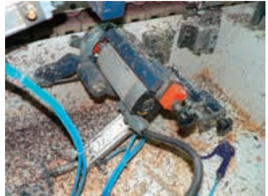
شکل ۱۷۴-۱۶- تنظیم توپی فرز پرداخت لبه نوار.
