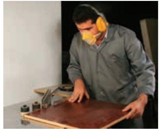
شکل ۱۳۸-۱۶- استفاده از وسایل حفاظتی.
