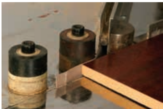
شکل ۱۳۷-۱۶- لبه اضافه نوار در شیار سطح صفحه ماشین.
