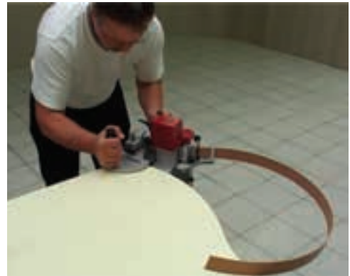
شکل ۱۰۸-۱۶. لبه چسبانی با دستگاه قوسی.
