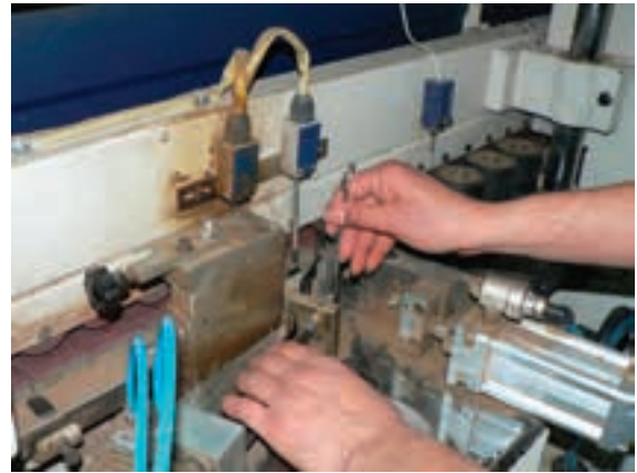
شکل ۱۷۰-۱۶- میکروسوئیچ فتری عمودی در ایستگاه غلطک چسب.
