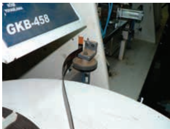
شکل ۱۶۶-۱۶- عبور دادن سر نوار به داخل ماشین از شیار مربوطه.
