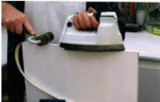
شکل ۶۱-۱۶- لبه چسبانی نوار PVC با اطو.
