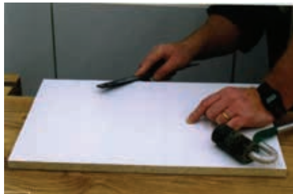
شکل ۸۱-۱۶- برطرف کردن تیز لبه صفحه با سوهان نرم.
