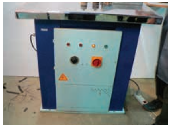
شکل ۳۸-۱۶- کلید روشن کردن و درجه تنظیم حرارت ماشین.
