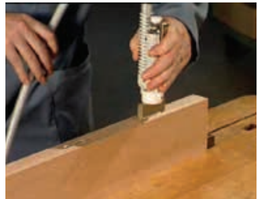
شکل ۴۵-۱۶. اتصال شیلنگ چسب به دستگاه چسب‌زن پنوماتیک.
