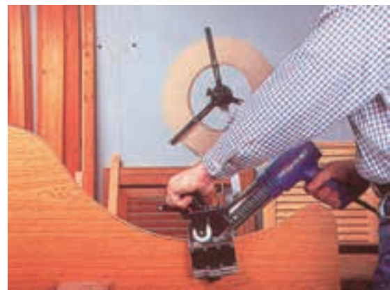
شکل ۷۰-۱۶- نوار چسبانی با لبه چسبان غلطکی دستی.
