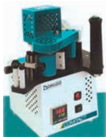
شکل ۹۱-۱۶. دستگاه منمنی و مستقیم لبه‌چسبان دستی و میزی با سرعت ۱ تا ۱۴ متر در دقیقه، قدرت موتور ۰/۲۵ اسب، ضخامت نوار ۰/۴ تا ۳ میلیمتر.
