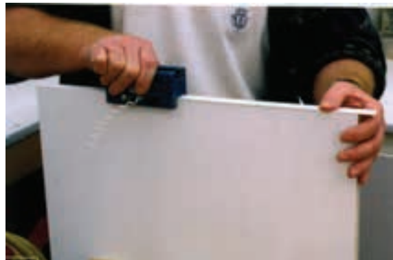
شکل ۸۰-۱۶- قیچی پرداخت دو طرفه لبه نوار.
