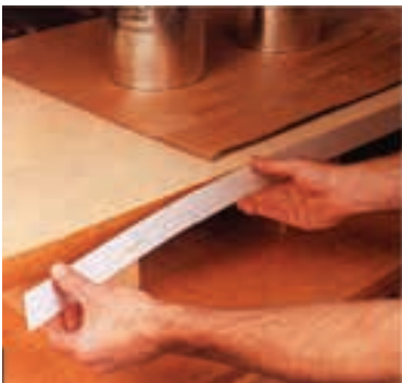
شکل ۱۶-۶۵- استقرار دقیق نوار لبه چسبان (وی چسب).
