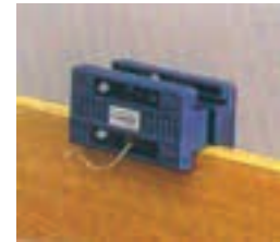
شکل ۳۴-۱۶- پرداخت کردن لبه.
