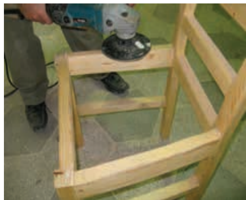
شکل ۳۷-۶- پرداخت کاری قبل از بتونه.
