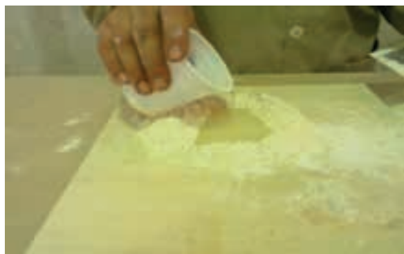
شکل ۴۸-۶- از ترکیب مل، سریشم و آب بتونه سریشی ساخته می‌شود.
