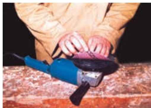
شکل ۵-۳۰- نمونه چسباندن سنباده به صفحه ی دستگاه.
