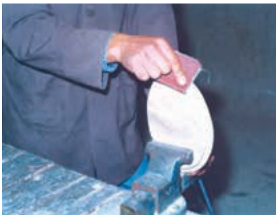
شکل ۲۲-۴- عده استفاده از چوب کمکی.
