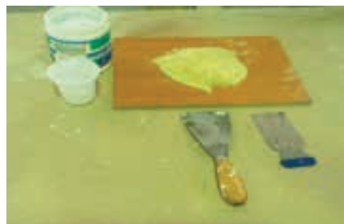
شکل ۶-۶- از ترکیب فاک اره، چسب سریشم و در صورت نیاز مقدار کمی آب بتونه سریشمی به دست می‌آید.
