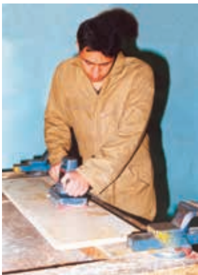
شکل ۵-۴۳- سنباده‌کاری در جهت الیاف.
