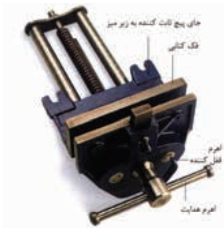
شکل ۸-۶- گیره کله‌گی کتابی فلزی با زبانه کشویی و حرکت قفل شونده.
