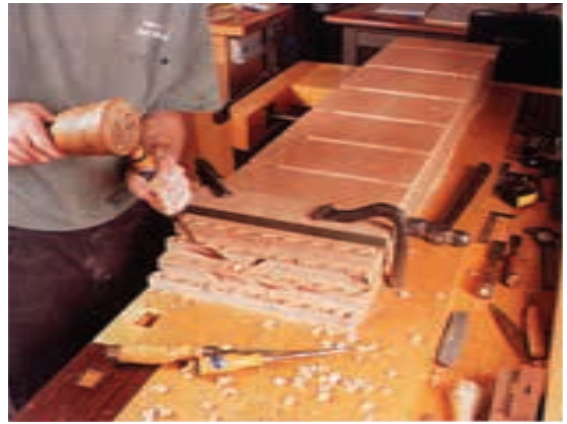
شکل ۱۶-۶- مغارکاری و ثابت کردن صافه کار با استفاده از آهن نگهدارنده اهرمی.
