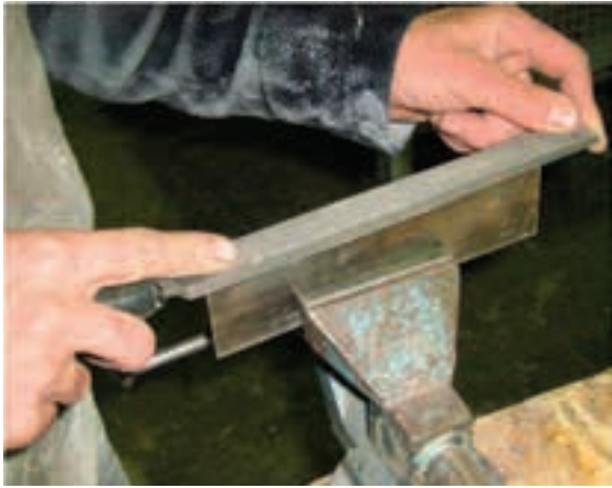
شکل ۱۰-۳- سوهان کشیدن روی نر لیسه.
