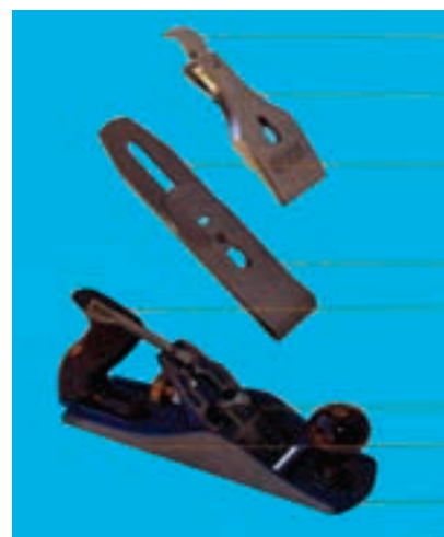
شکل ۲۳-۳ - رنده آهنی و تیغه‌های آن.
