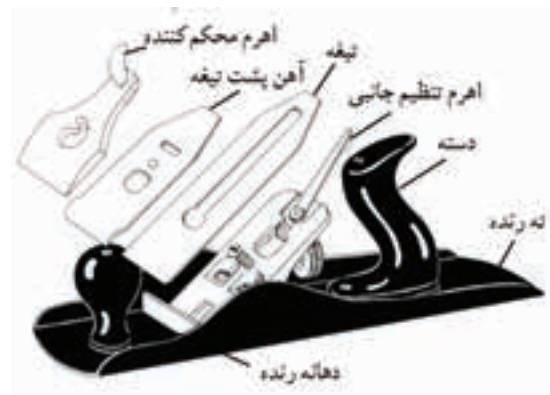
شکل ۳-۵۱- قسمت‌های مختلف رنده دو تیغ آهنی.
