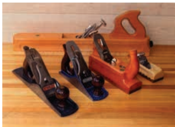
شکل ۲۲-۳ - انواع رنده‌های چوبی و آهنی.
