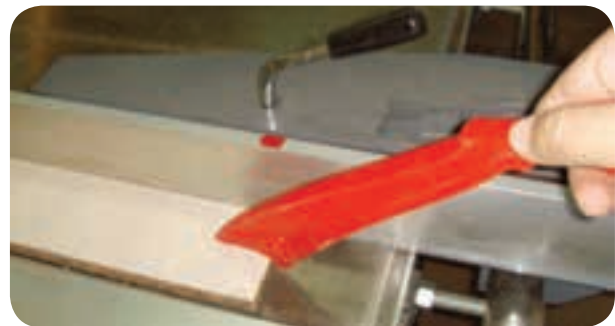
شکل ۱۲۴-۵ هل دادن قطعه باریک با فیکسچر ساده
