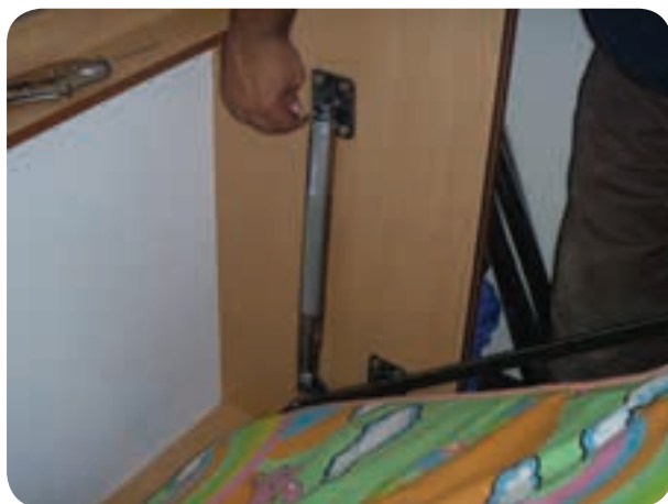
شکل ۱۵۶-۵ تنظیم فشار گاز سیلندر برای تعادل تختخواب
