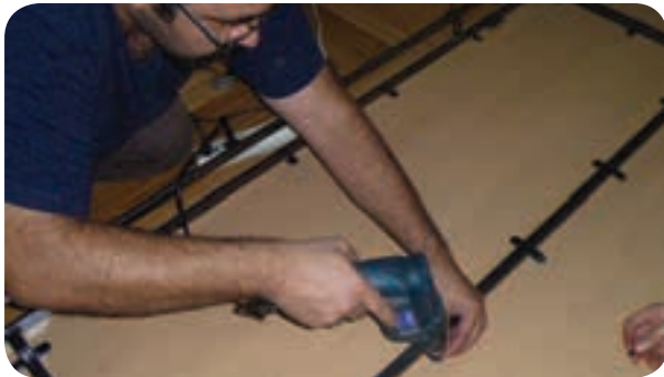
شکل ۱۴۹-۵ استقرار کلاف فلزی روی صفحه جلو تختخواب
