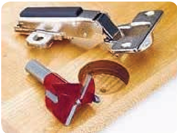
شکل ۱۶۸-۵ ایجاد جای لولای گازی در چوب به وسیله مته مخصوص
