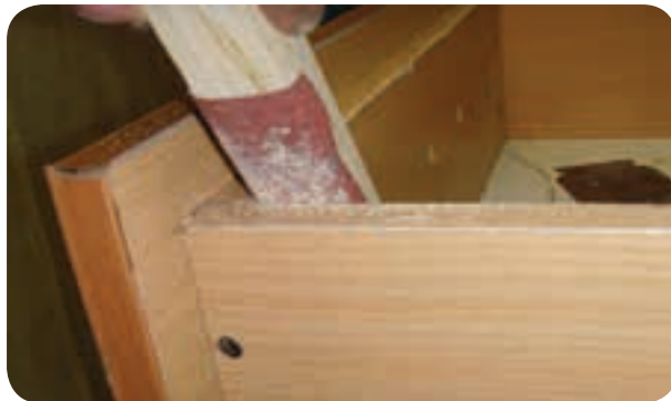
شکل ۲۰۲-۵ برطرف کردن لبه تیز صفحات با سوهان
