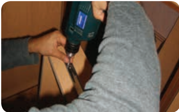
شکل ۱۹۶-۵ نصب ریل تکی به بدنه کشو
