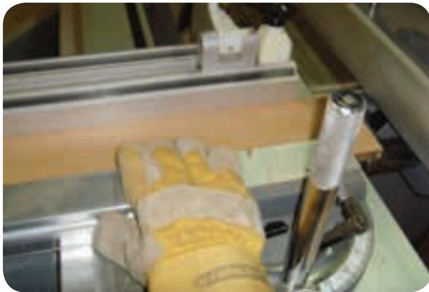
شکل ۱۲۶-۵ استفاده از گونیای کشویی میز متحرک ماشین ارّه پانل‌بر
