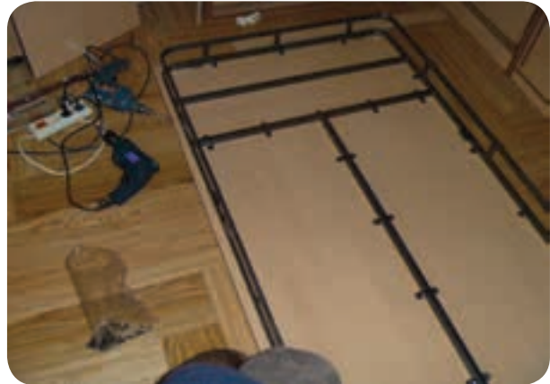
شکل ۱۴۹-۵ استقرار کلاف فلزی روی صفحه جلو تختخواب
