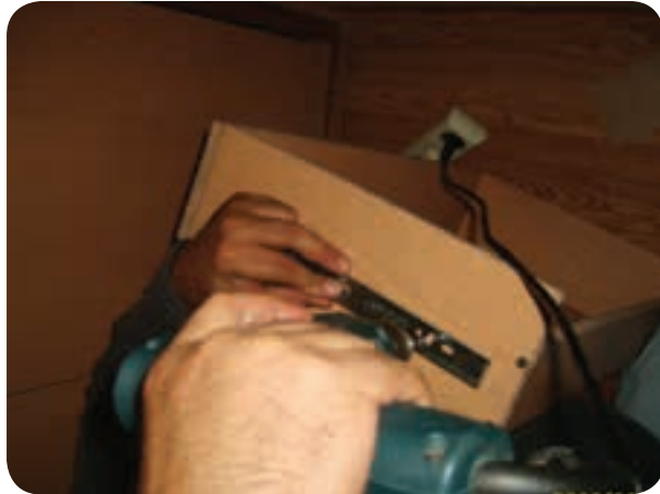
شکل ۱۷۵-۵ نصب ریل تکی تلسکوپي سه کشویی روی بدنه کشو
