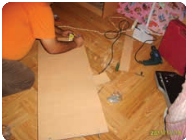
شکل ۱۴۲-۵ علامت‌گذاری و تعیین محل سوراخ‌ها
