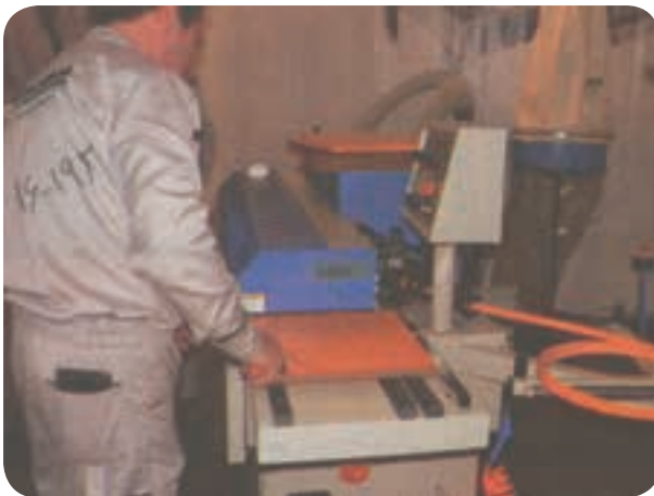
شکل ۱۳۷-۵ نوار چسبانی PVC با ماشین لبه چسبان
