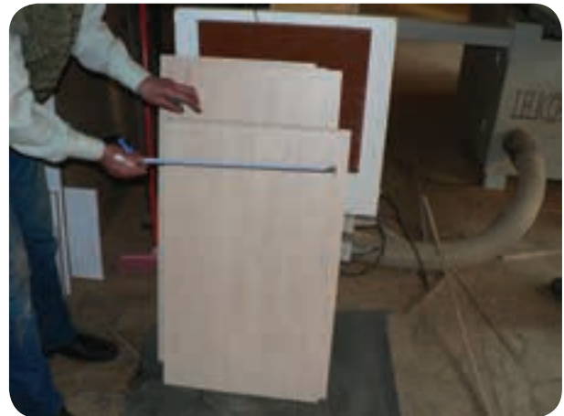
شکل ۱۳۵-۵ کنترل اندازه قطعات آماده شده
