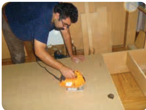
شکل ۱۸۲-۵ نصب فیبر پشت‌بند و در آوردن جای عبور سیم برق روی آن
