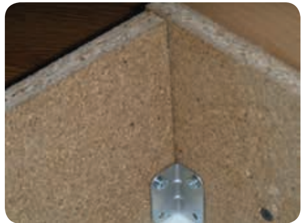
شکل ۱۷۴-۵ اتصال جلو و عقب جعبه به وسیله گونیا فلزی گوشه کار
