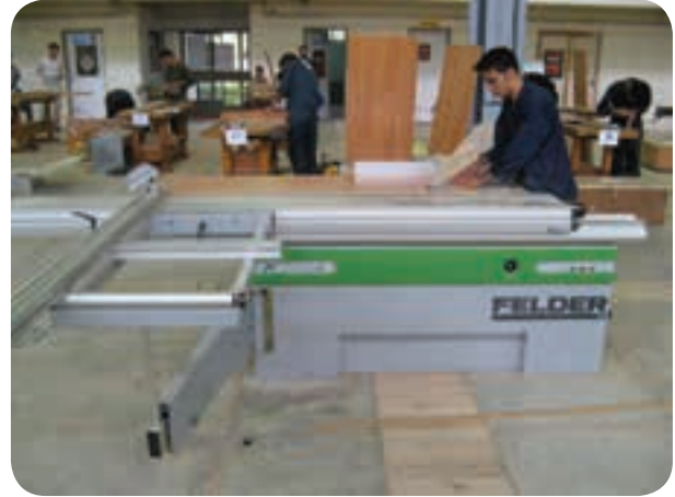
شکل ۱۳۴-۵ برشکاری قطعات سقف و کف
