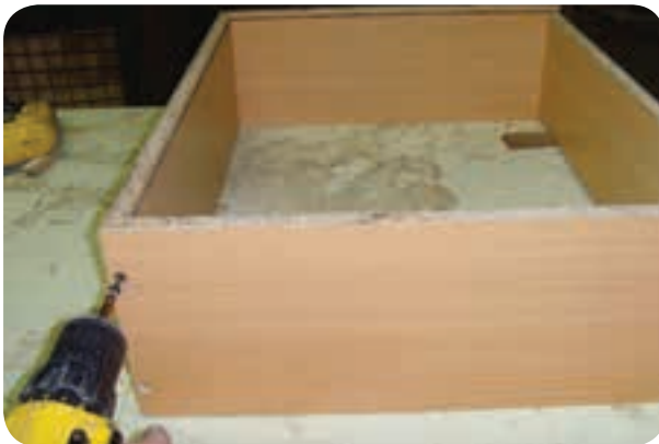
شکل ۱۷۲-۵ پیچ کردن جلو و عقب داخل جعبه کشو به بدنه‌ها
