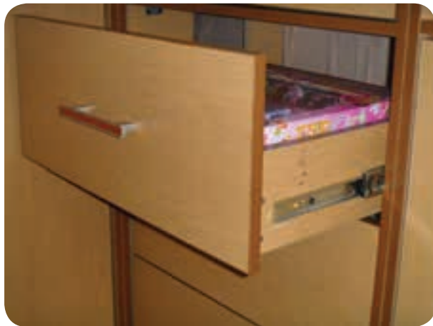
شکل ۱۷۶-۵ کشو مجهز به ریل تلسکوپي سه ریله ضامن‌دار
