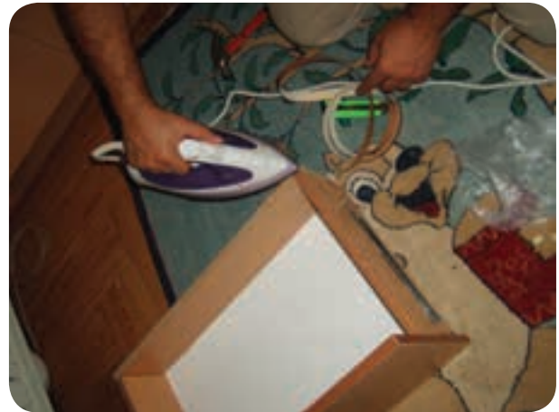
شکل ۱۷۳-۵ نوار چسبانی به نر (ضخامت) کشوها با اتوی داغ
