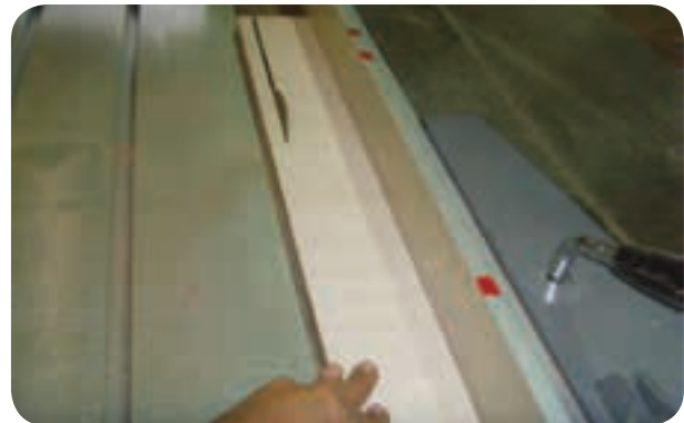
شکل ۱۲۳-۵ خطر پس زدن و پرتاب قطعه وجود دارد
