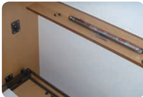
شکل ۱۵۴-۵ جا انداختن محور پایه کلاف فلزی در براق مربوطه
