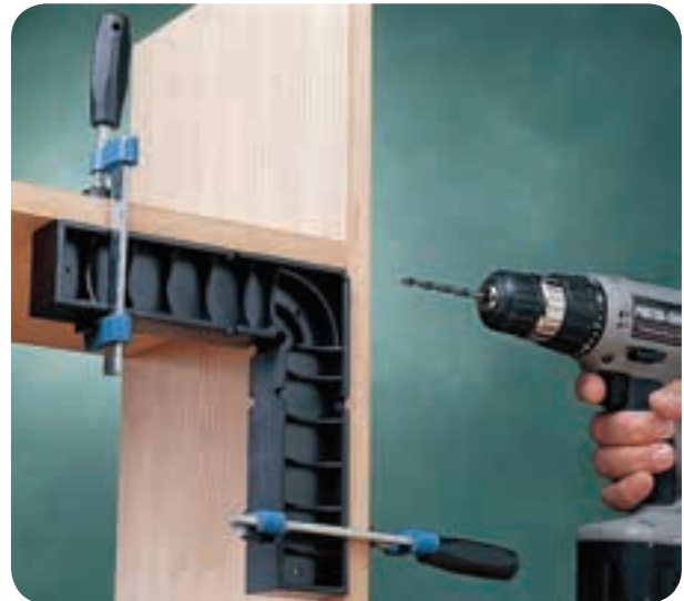
شکل ۱۹۰-۵ استفاده از شابلون برای جلوگیری از دوئدگی
