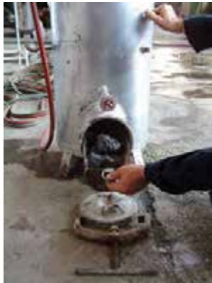
شکل ۲-۳۴ - قراردادن کاربید در محفظه‌ی مخصوص
