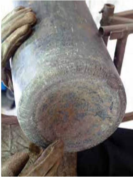
شکل ۲-۱۸- گودی ته کپسول اکسیژن
