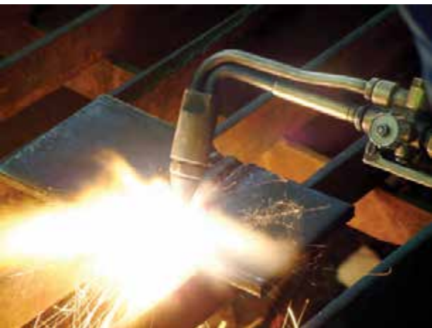
شکل ۲-۶- برشکاری با گاز
