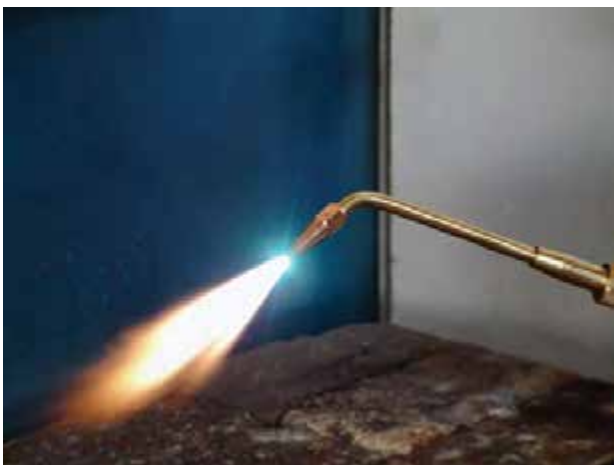
شکل ۲-۳- شعله‌ی سوختن گاز استیلن با اکسیژن
