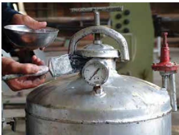
شکل ۲-۳۸- کنترل نشستی گاز
