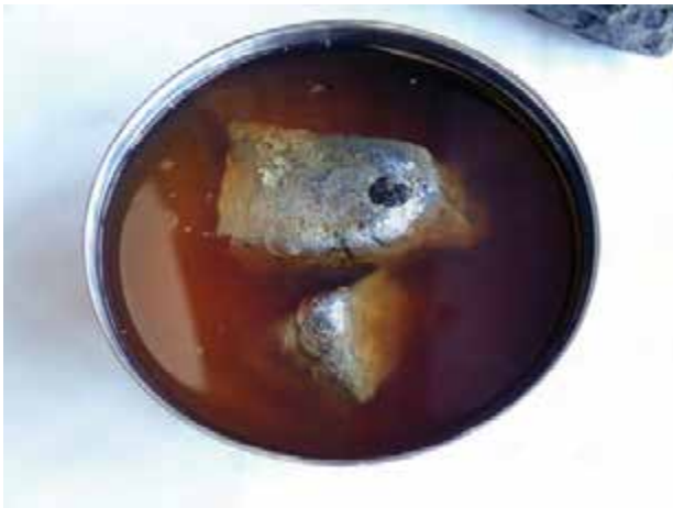
شکل ۱۲-۲- نگهداری کاربید در زیر نفت
