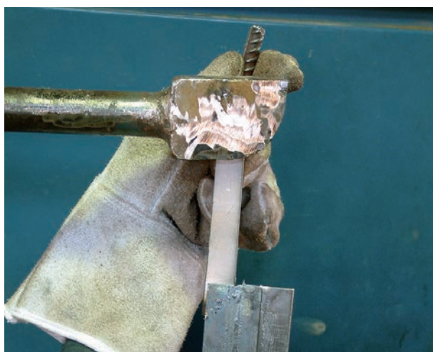
شکل ۱۲۹-۲- نحوه‌ی بستن قطعه به گیره
