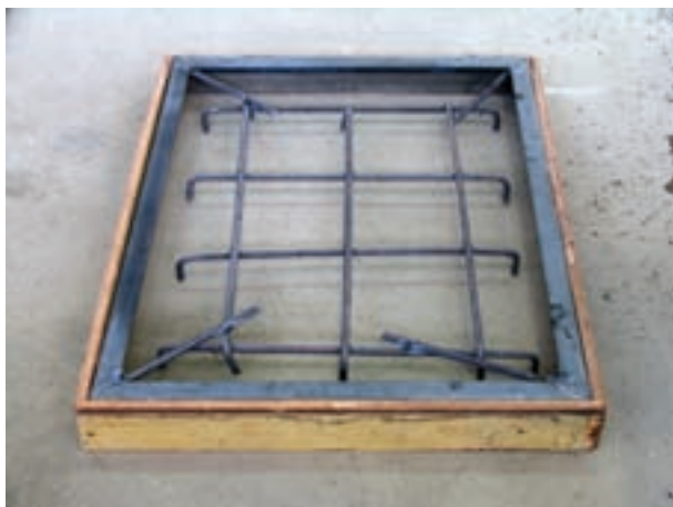
شکل ۵-۱- قرارگیری میل‌گردها در قالب
