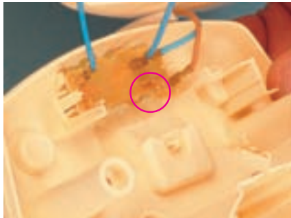
الف - پلاتین‌ها در حالت قطع
