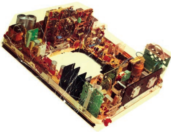
شکل ۱۹۹-۴ - یک نمونه شاسی تلویزیون رنگی قدیمی
