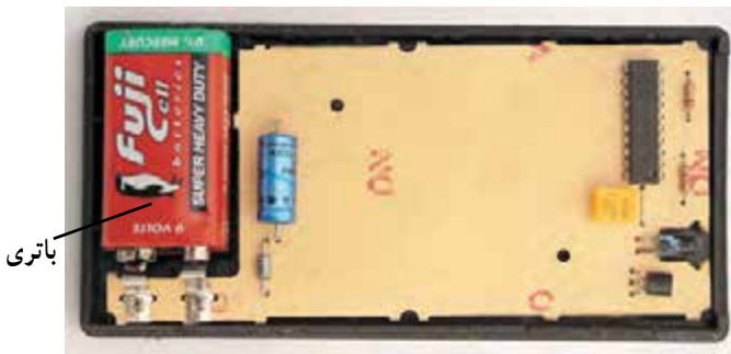
شکل ۳-۴۵- برد کنترل از راه دور و محل قرار گرفتن باتری
