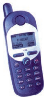
شکل ۴-۳- تلفن بی‌سیم در داخل اتاق صدا برداری یک مولد نویز محسوب می‌شود.
