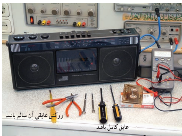
شکل ۳-۳۱- وسایل و ابزار مخصوص تعمیرات الکترونیکی
