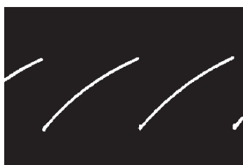
شکل ۲-۲-جریان دندانه اره‌ای
