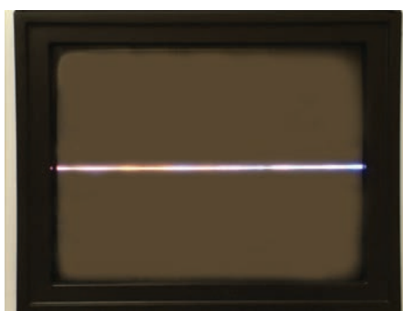
شکل ۲-۴۰- نوسان‌ساز عمودی از کار افتاده است.
