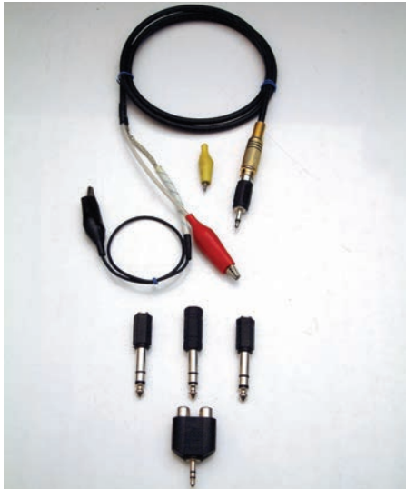
شکل ۳-۵۵- نحوی ساخت فیش رابط برای دریافت خروجی از دستگاه بخش صوت به صورت مونو
