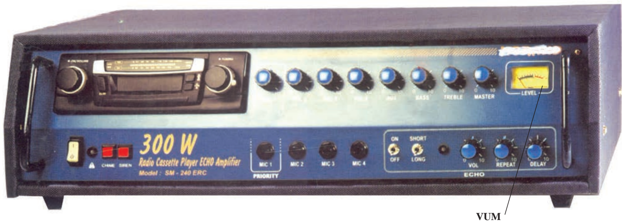
شکل ۱-۳- ابزار سنجش VUM در یک آمپلی فایر
