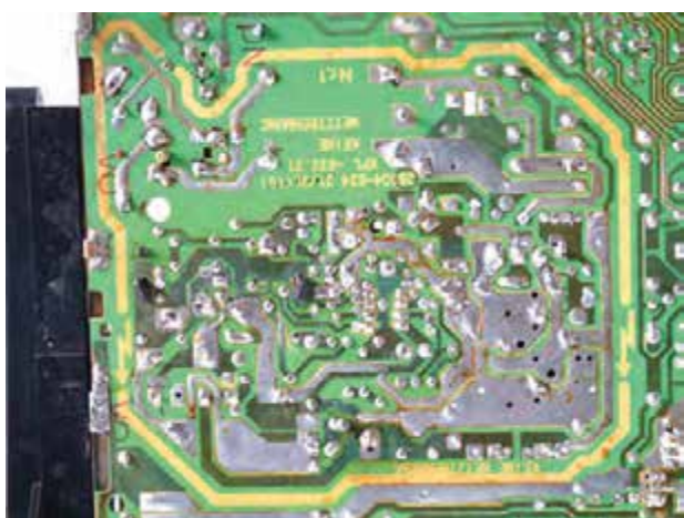
شکل ۱-۱۳۷- بخشی از مدار که برق ۲۲۰ ولت وجود دارد.
