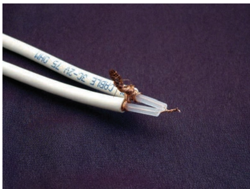
شکل ۱-۶۳- سیم کابل نباید دو تکه باشد.
