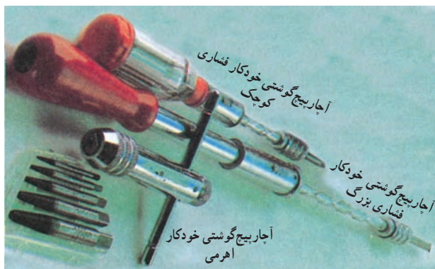
شکل ۴۰-۱- انواع پیچ‌گوشتهای خودکار دستی
