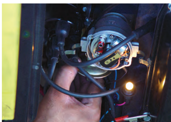
شکل ۹۳-۳- لحظه ی باز شدن دهانه پلاتین و روشن شدن لامپ
