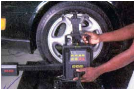
شکل ۳-۲۲۰ - نصب مجموعه حسگر دستگاه اندازه‌گیر رایانه‌ای
