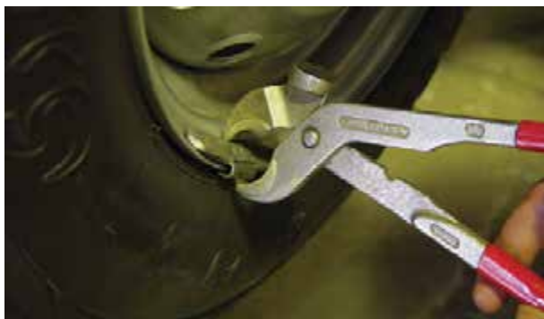
شکل ۲۳۳-۳- تمیز کردن و پیاده کردن سرب‌های قبلی
