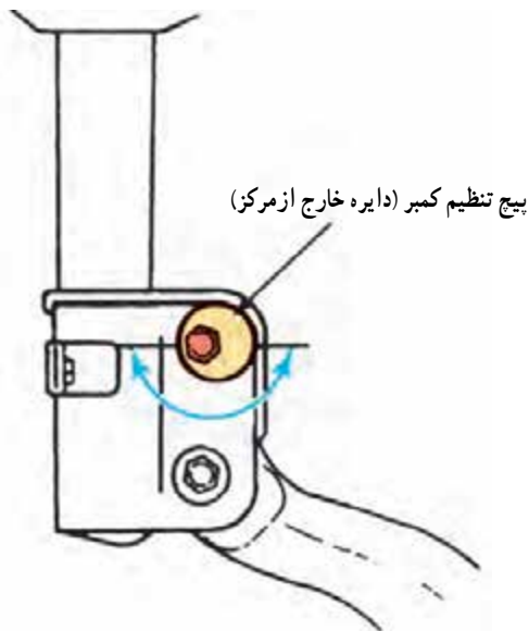
شکل ۲۲۵-۳- تغییر زاویه کمبر سیستم مک فرسون با پیچ تنظیم
