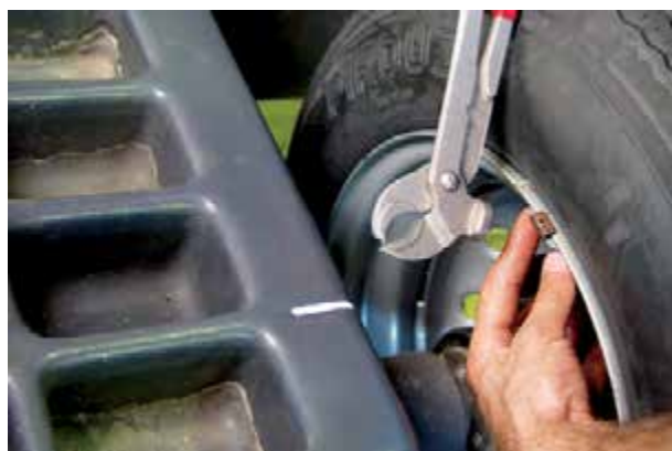
شکل ۲۳۹-۳- نصب وزنه روی قسمت داخلی رینگ
