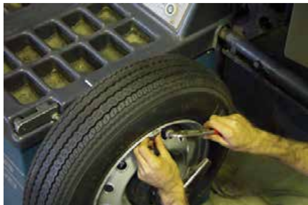
شکل ۲۳۸-۳- نصب وزنه روی قسمت بیرونی رینگ
