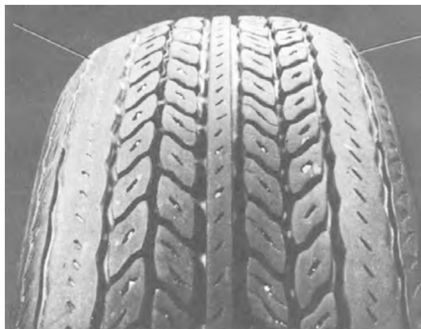
شکل ۲۱۴-۳- سایس در اثر رانندگی غلط (پیچیدن تند)
