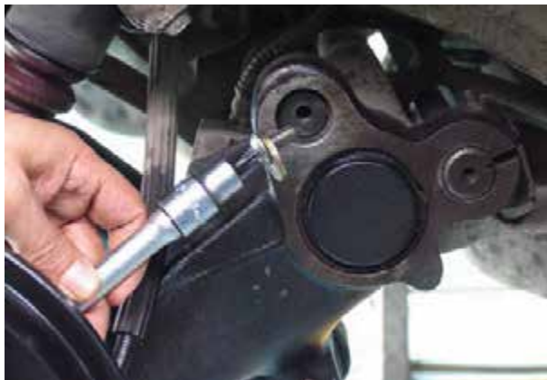
شکل ۱۷۶-۳- نصب واشر فشار و پیچ‌های انتهای میله‌ها
