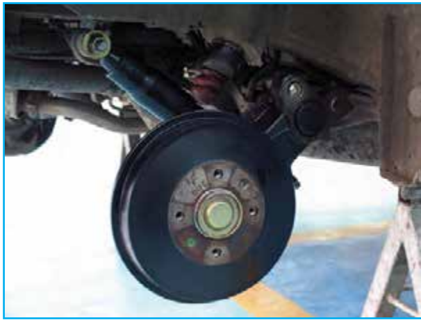
شکل ۱۸۳-۳- نصب ژامبون و متعلقات چرخ عقب
