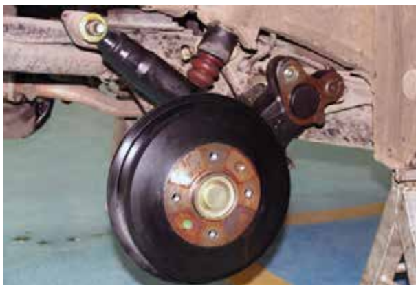
شکل ۱۷۷-۳- نصب کمک فنر
