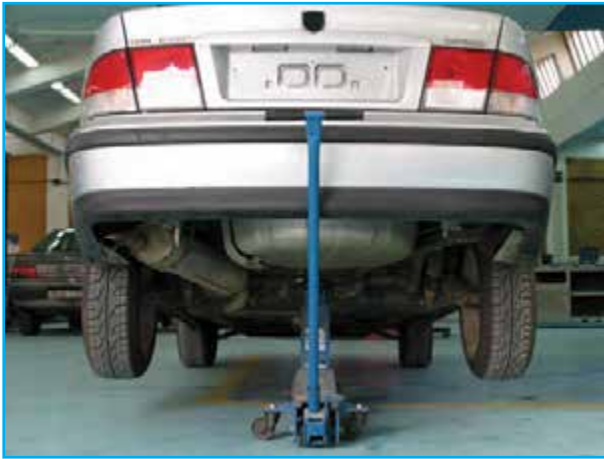
شکل ۳-۱۵۶ تنظیم ارتفاع و کنترل رام لوله‌ای
