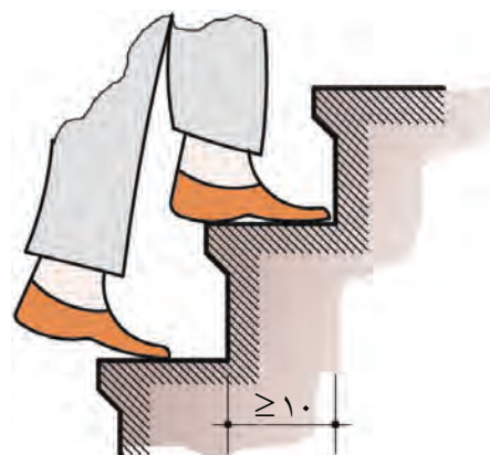
شکل ۱۶-۳ کوچک‌ترین اندازه‌ی کف پله در پله‌های پیچ
