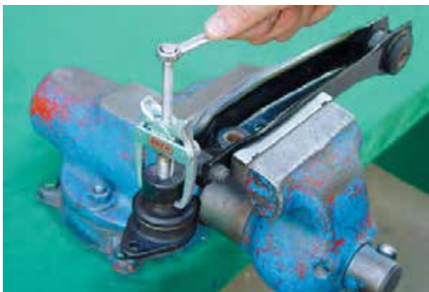
شکل ۳-۸۵- جدا کردن سیبک از بازوی اتصال
