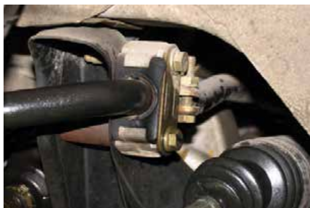
شکل ۱۳۲-۳- نصب بست‌های میل موج گیر بلند
