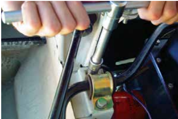
شکل ۳-۸۶- باز کردن میله ضد غلتش (موج گیر)
