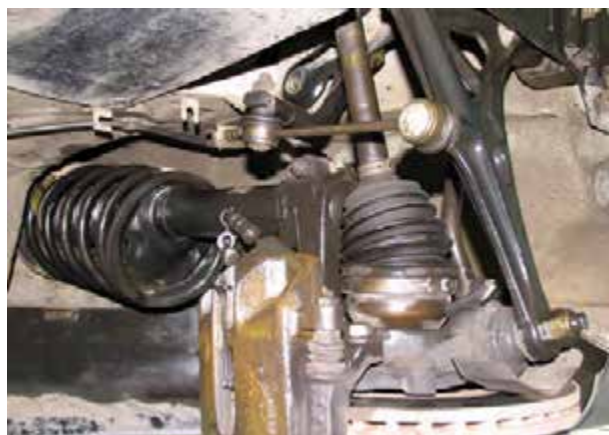
شکل ۱۳۱-۳- نصب میل موج گیر کوتاه
