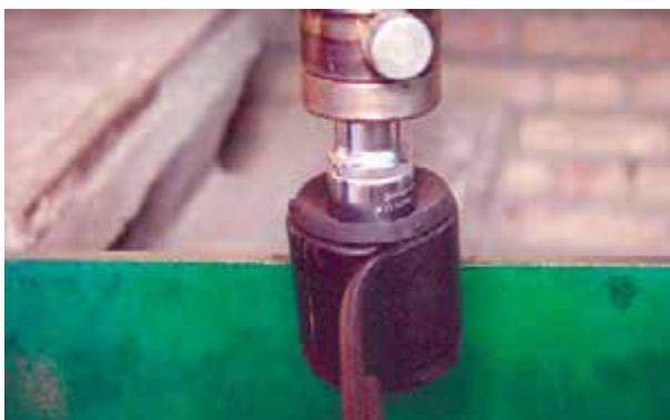
شکل ۳-۶۹- بوش لاستیکی فلزی محل اتصال شاه فنر
