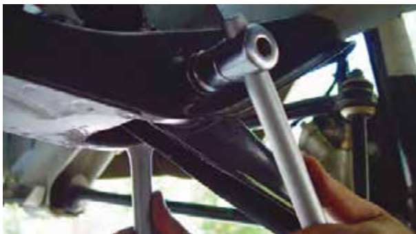
شکل ۳-۸۳- باز کردن طبق از رام
