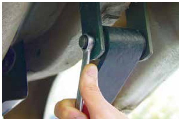
شکل ۳-۶۵ – باز کردن مهره‌های گوشواره فنر شمش
