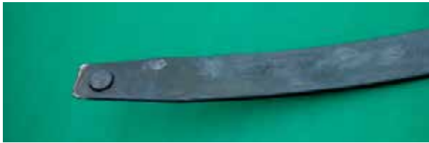
شکل ۷۰-۳- لاستیک‌های محافظ انتهایی لایه‌های فنر شمش
