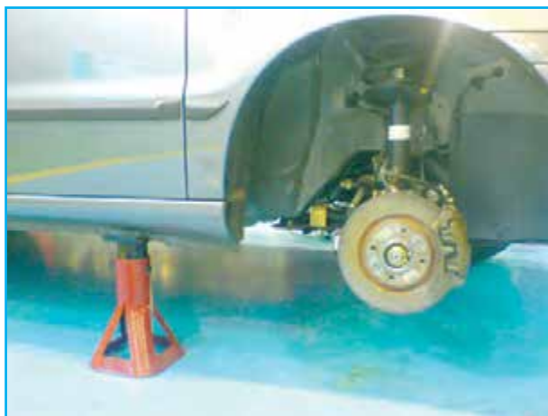
شکل ۳-۶۱- خودروی مستقر بر پایه قابل تنظیم
