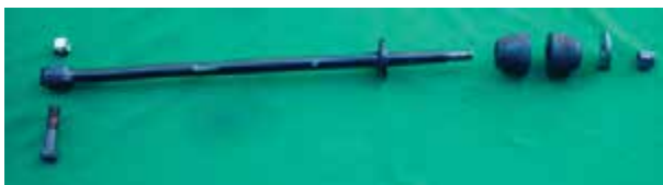
شکل ۳-۸۴- اجزای میل تعادل
