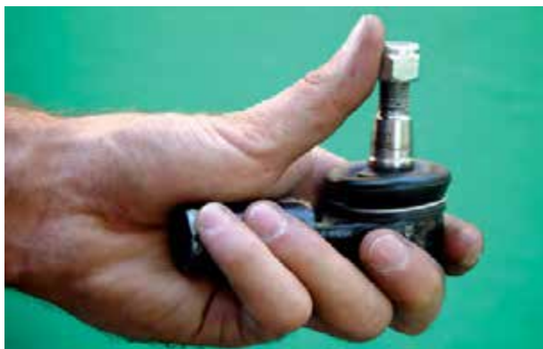
شکل ۸۴-۲- کنترل لقی سیبک‌ها
