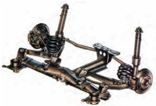
شکل ۳-۴۸- سیستم تعلیق مستقل عقب با چرخ‌های متحرک
