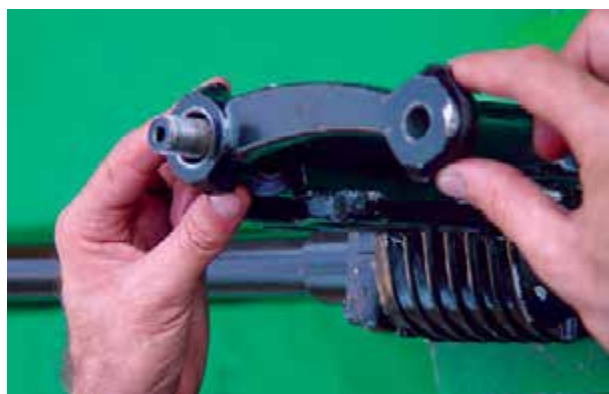
شکل ۲-۵۹- پیاده کردن اهرم هزار خار
