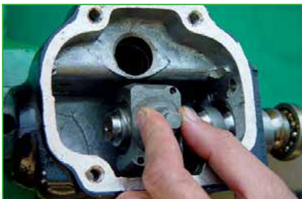
شکل ۲-۶۳- خارج کردن محفظه ساچمه‌ها
