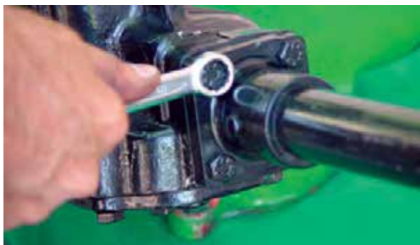
شکل ۲-۶۰- باز کردن پیچ‌های لوله فرمان
