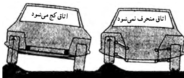
شکل ۹-۳- خودرو با سیستم تعلیق فعال
