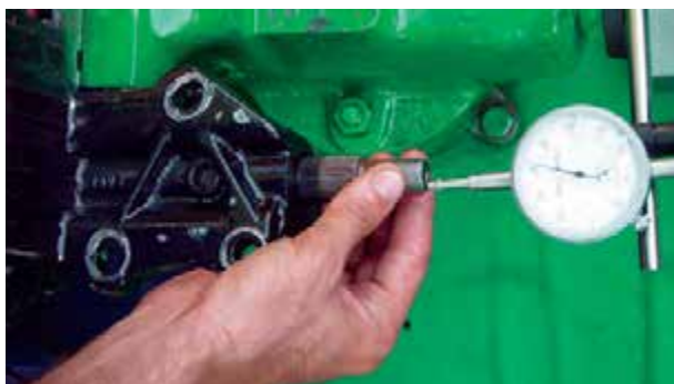
شکل ۷۰-۲- اندازه‌گیری لقی طول محور هزار خار
