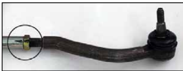
شکل ۲-۷۴ - علامت گذاری سبیک و میل رابط
