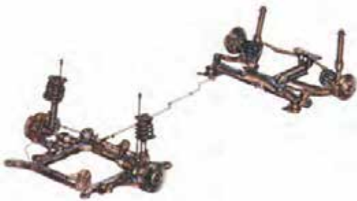
شکل ۳-۴۱- سیستم تعلیق عقب و جلو خودرو
