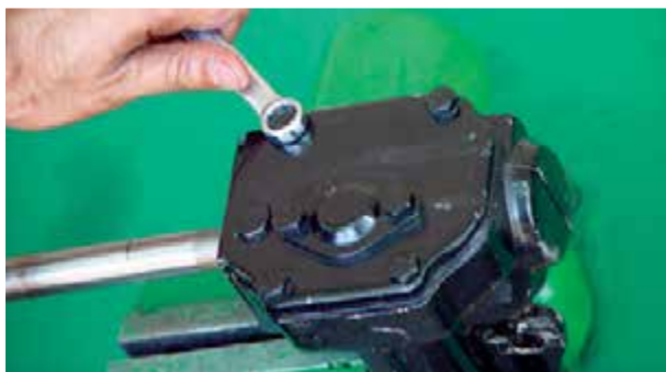
شکل ۲-۶۲- باز کردن درپوش بالایی جعبه فرمان
