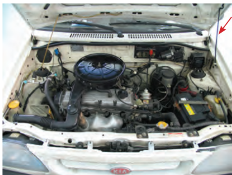
شکل ۱۱۹- نصب صحیح اهرم نگه‌دارنده درپوش موتور خودرو
