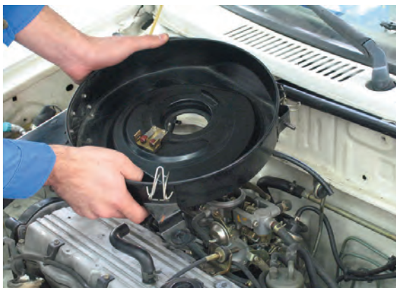
شکل ۱۰۰- پیاده کردن مجموعه‌ی هواکش.
