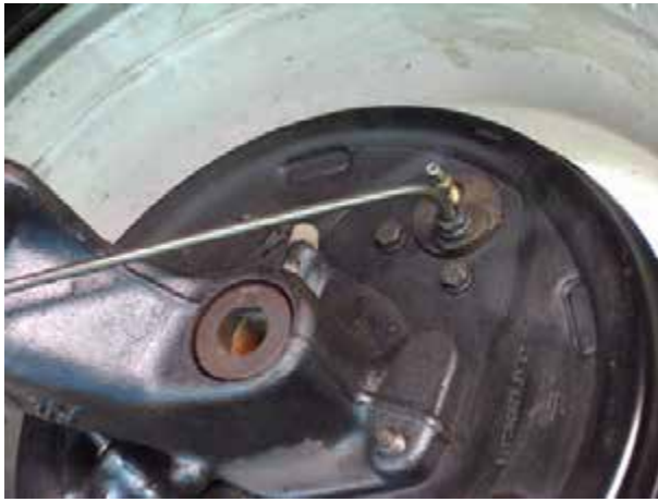
شکل ۱-۱۰۳- پاک کردن اطراف اتصالات
