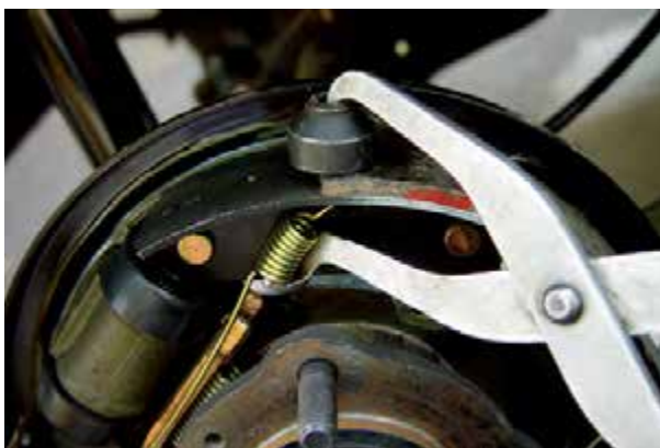
شکل ۱-۱۰۷- جازدن فنر بالایی کفشک
