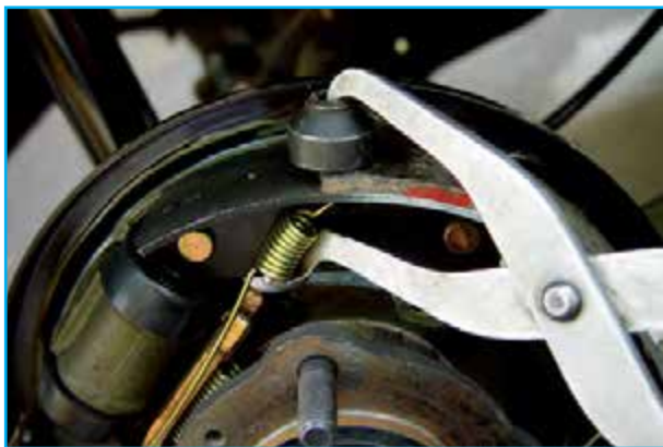
شکل ۹۱-۱- خارج کردن فنر بالایی
