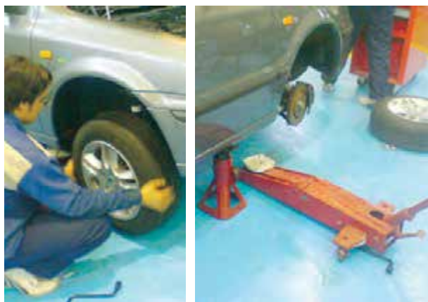
شکل ۱-۱۱۷-۱- بالا بردن و پیاده کردن چرخ جلو
