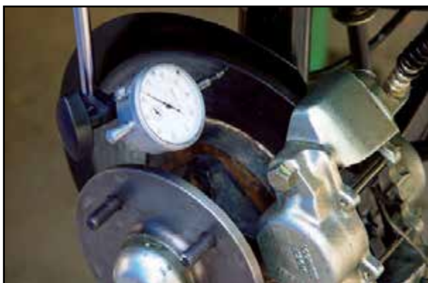
شکل ۱-۱۲۳- بررسی وضعیت دیسک
