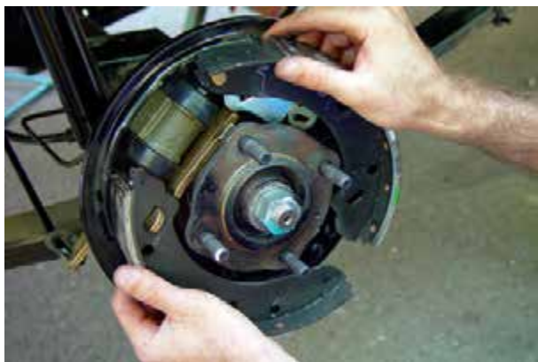
شکل ۹۳-۱- خارج کردن کفشک‌ها
