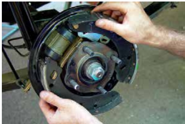
شکل ۱-۱۰۴- خارج کردن کفشک‌ها
