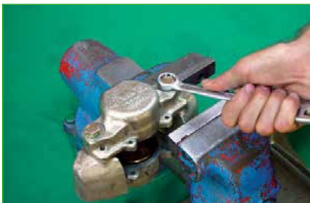
شکل ۱-۱۲۰- باز کردن پیچ های کالیپر
