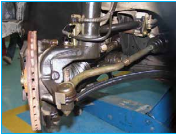
شکل ۱-۱۱۸- باز کردن مهره لوله ترمز
