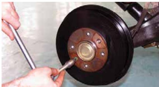
شکل ۱-۸۹ – باز کردن پیچ کاسه چرخ
