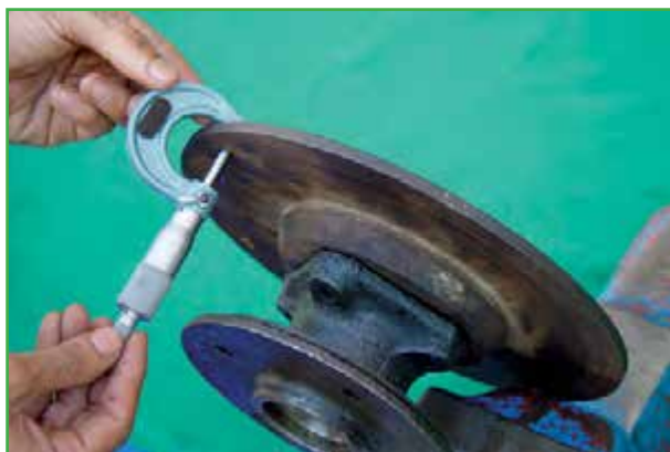
شکل ۱-۱۲۴- اندازه‌گیری ضخامت دیسک
