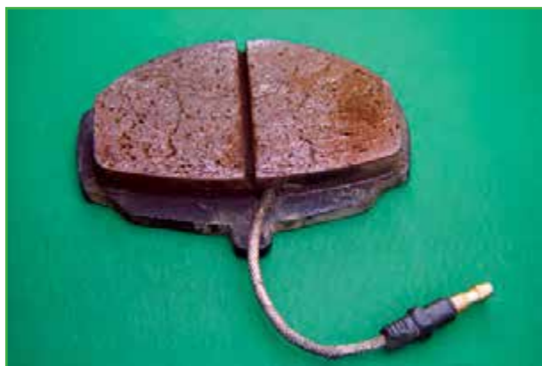
شکل ۱۱۲-۱- لنت ترمز دارای سیم هشدار
