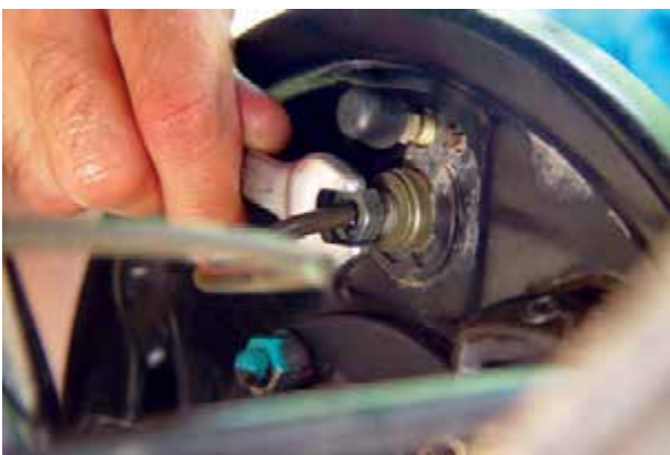
شکل ۱-۱۰۵- باز کردن مهره اتصال لوله ترمز
