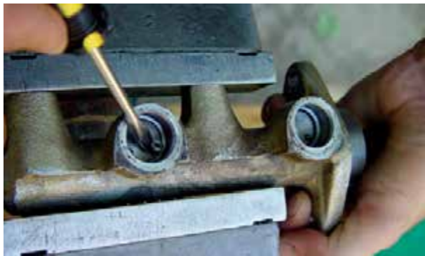
شکل ۱-۱۳۱- بستن سیلندر اصلی به گیره
