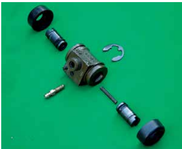
شکل ۹۵-۱- اجزای پمپ ترمز چرخ
