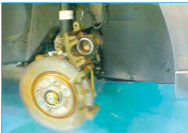
شکل ۱۱۰-۱- باز کردن پوسته نگه‌دارنده لنت‌ها
