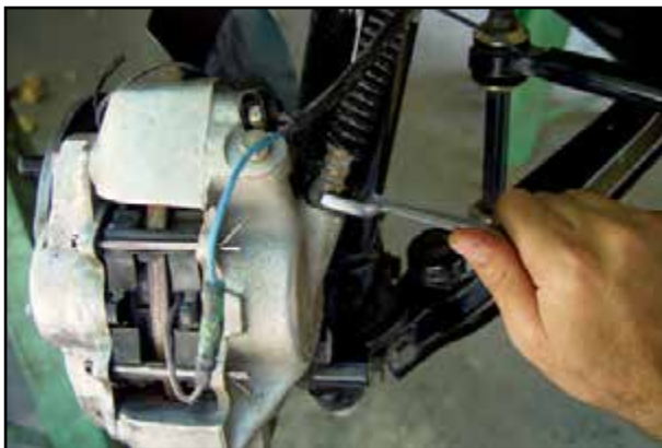
شکل ۱-۱۱۹- باز کردن شیلنگ ترمز
