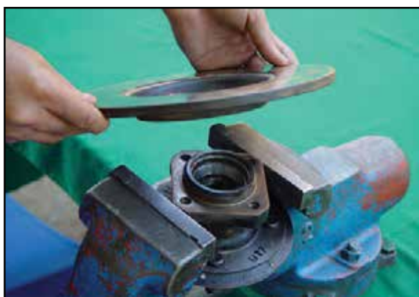
شکل ۱-۱۲۶- بازکردن دیسک ترمز
