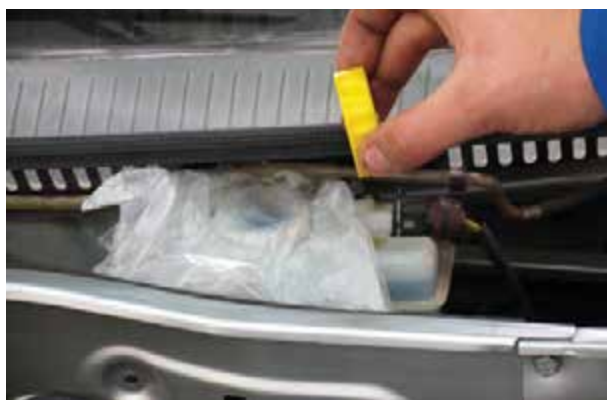
شکل ۱۳۸-۱- مسدود کردن در مخزن مایع ترمز
