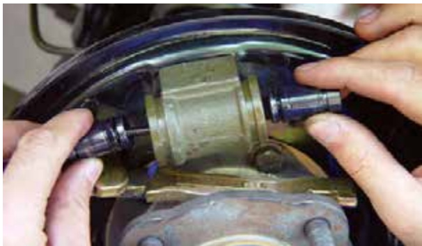
شکل ۹۴-۱- خارج کردن پیستون‌ها
