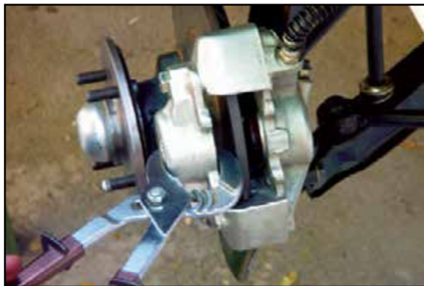
شکل ۱۱۴-۱- عقب راندن پیستون ترمز دیسکی
