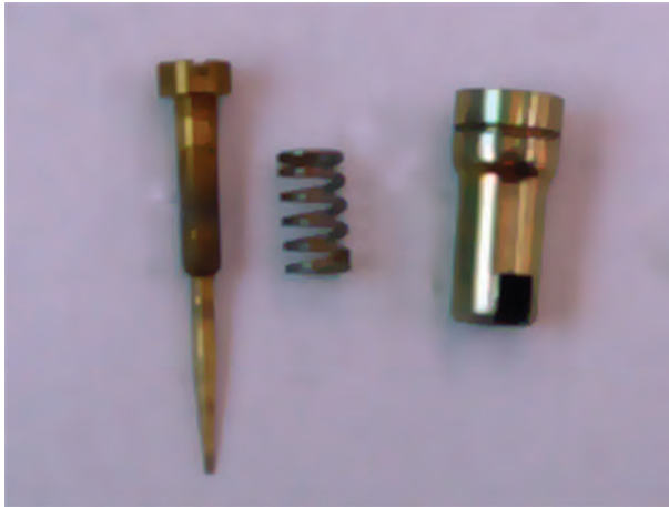
شکل ۱-۷۴ پیچ مخروطی و فنر تثبیت کننده‌ی سوخت دور آرام
