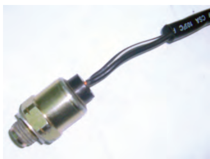
شکل ۱-۹۲ سلونوئید مدار دور آرام
