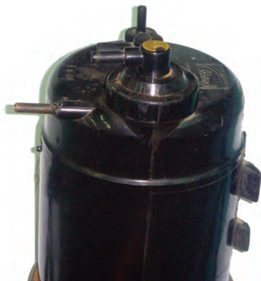
شکل ۱-۹۶ شیر ورودی سوخت‌های تبخیر شده به کنیستر
