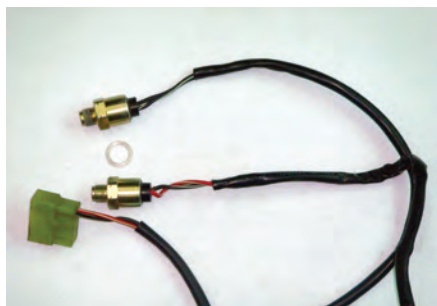
شکل ۱-۹۱ اجزای الکتریکی در یک نوع کاربوراتور
