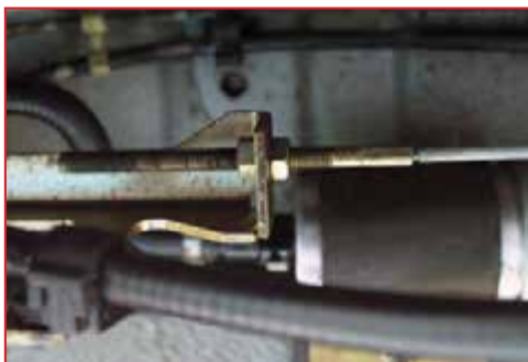
شکل ۴۸-۱- باز کردن مهره تنظیم کننده
