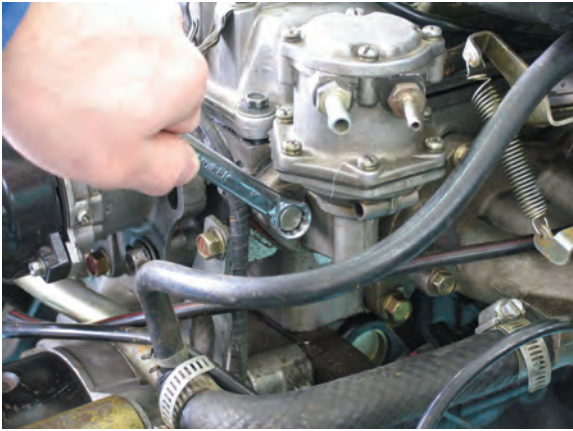
شکل ۱-۴۲ پیاده کردن پمپ
