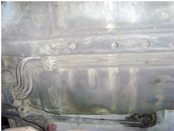
شکل ۱-۳۳ لوله‌ی سوخت از مخزن تا پمپ
