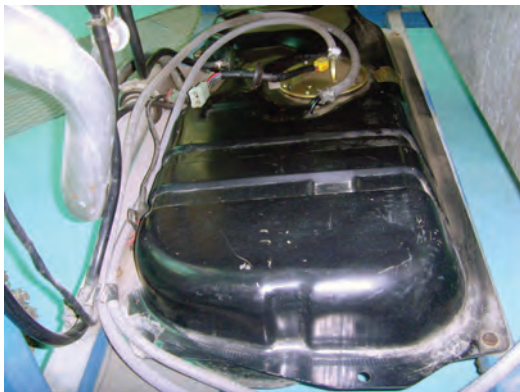
شکل ۱-۲۷ مخزن نصب شده و آماده سوخت گیری
