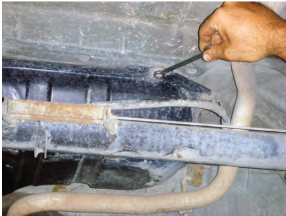
شکل ۱-۲۵ باز کردن پیچهای دور باک
