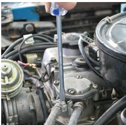
شکل ۱-۴۴-ب: نصب لوله‌ها
