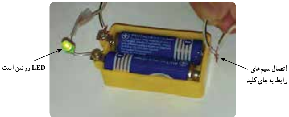
شکل ۹-۳ مدار ساده با LED
