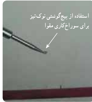
شکل ۳-۴- ایجاد سوراخ توسط نوک تیز بیج گوشتی یا پرگار
