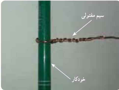
شکل ۳-۴- شکل‌دهی سرسیم مفتولی به صورت دایره
