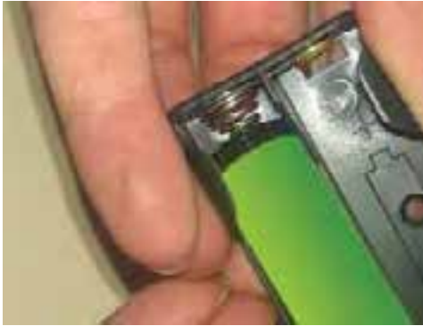
۲- قرار دادن باتری قلمی اول در جای باتری به طور صحیح
