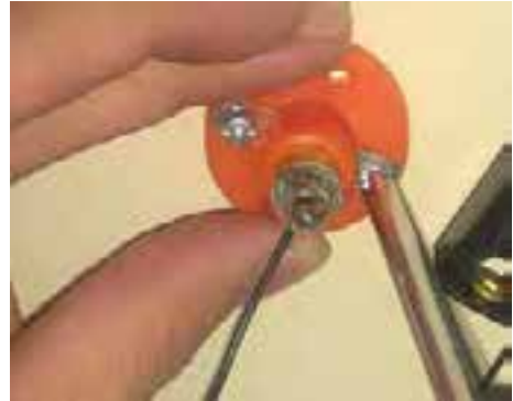
۱- بستن لامپ ۳ ولتی روی سریچ و بستن دو سرسیم جای باتری به دو سر اتصال سریچ
