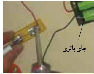
۱- جدا کردن سر یک سیم جای باتری و اتصال دادن آن به محل اتصال کلید اهرمی
