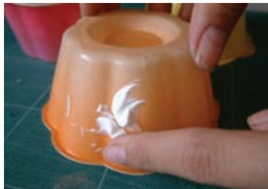
۱- زدن ماده جداکننده به مدل
