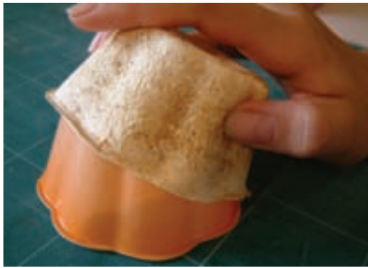
۴- خروج قطعه از روی مدل
