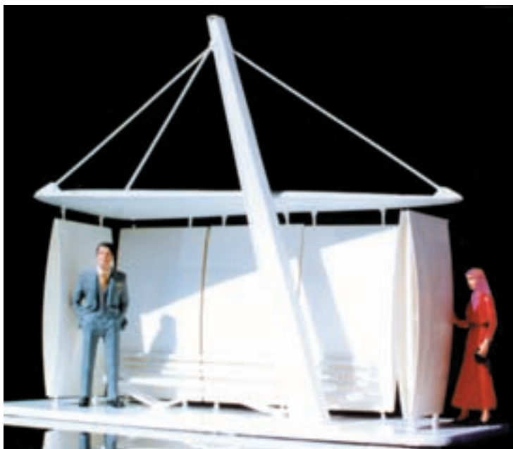
شکل ۸ — جنس ماکت از ورقهای P.V.C
