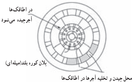
شکل ۶-۶- کوره های هوفمان حلقه ای و حلقه ای کشیده
