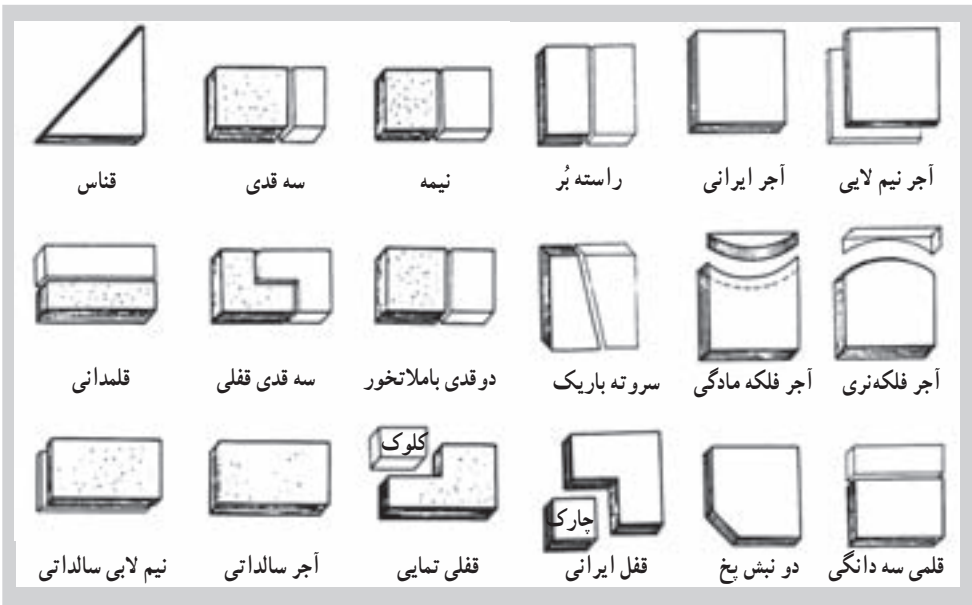
۱۳-۶- اجزای آجر و انواع تراش‌های روی آن
