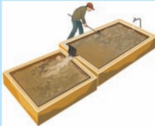
تهیه‌ی آهک شکفته به روش تر (دوغابی)
