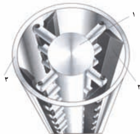
۱- محور چرخنده ۲- تیغه ۳- بدنه استوانه
