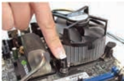
شکل ۲-۲- نحوه قرارگیری پردازنده
