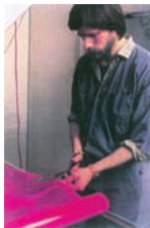
شکل ۱۴-۱۱- برش فیلم استنسیل
