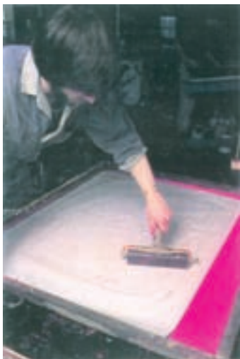
شکل ۱۹-۱۱- عملیات انتقال استنسیل به سطح توری را نشان می دهد. پس از انتقال، حدود دو ساعت برای خشک شدن توری وقت لازم است تا بتوان ورقه ی پشت استنسیل را جدا کرد.
