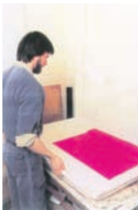
شکل ۱۷-۱۱- سخت کردن فیلم فتواستنسیل (بعضی از انواع فتواستنسیل نیاز به سخت شدن در این مرحله دارند و برای مدت یک دقیقه در وان پری اکسید هیدروژن قرار می گیرند. این عمل باعث سفت تر شدن لایه ی ژلاتینی آنها می شود).
