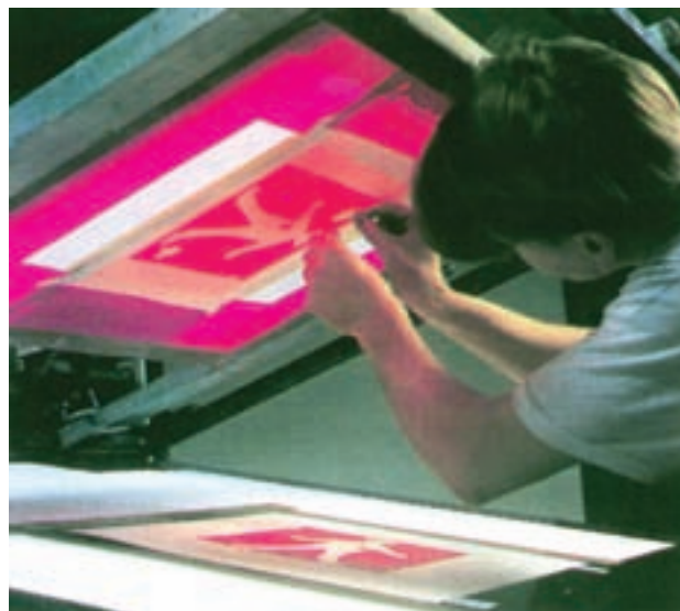
شکل ۲-۱۱- استفاده از استنسیل کاغذی
