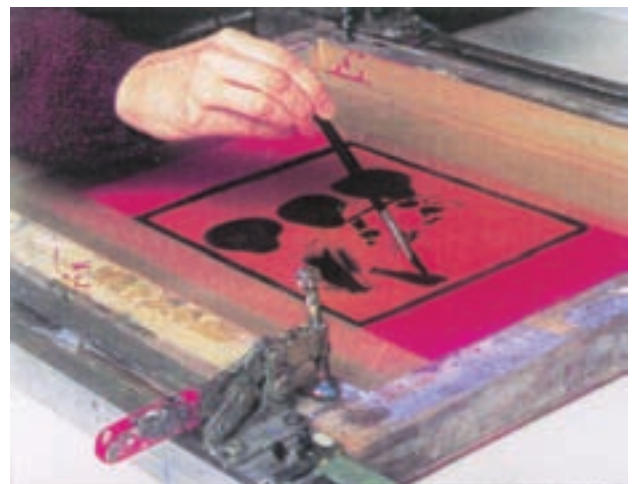
شکل ۱۱-۴- نقاشی بر سطح توری با استفاده از مرکب لیتوگرافی
