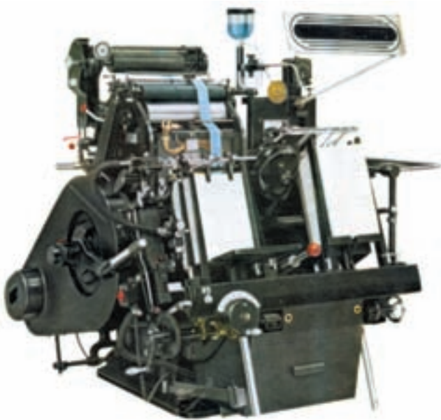
شکل ۲-۲- ماشین تیگل، سیستم بوستون معروف به ملخی
