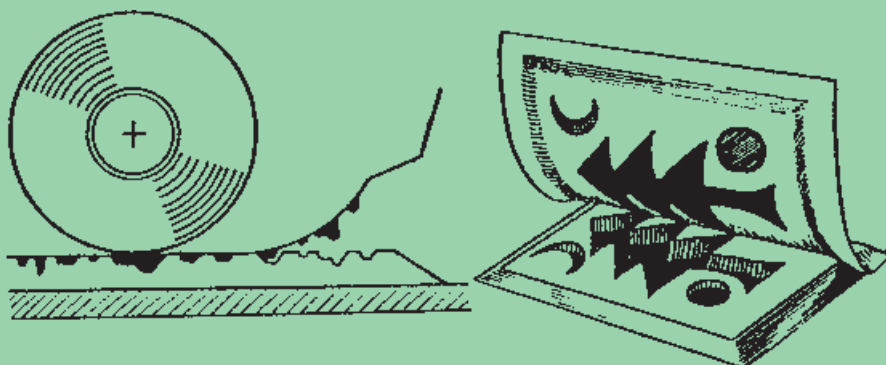
شکل ۳-۱- سمت چپ: فرم گود، کاغذ چاپ شده، سیلندر فشار سمت راست: فرم چاپی، کاغذ چاپ شده
