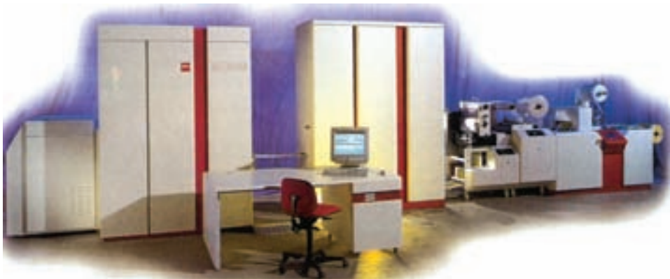
شکل ۱۷-۳- دستگاه چاپ دیجیتالی برجست زایکون (Xeikon) و مراحل تکمیلی از کارخانه نیل‌پیتتر (Nilpeter)
