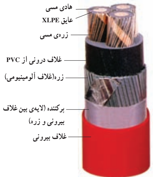
شکل ۴-۳۹- کابل با غلاف آلومینیومی
